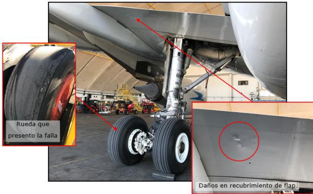
Figura 1. Posición de la rueda afectada y daños ocasionados al flap
