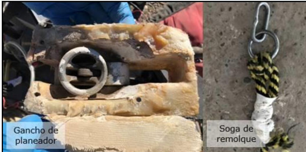
Figura 12. Gancho y soga de remolque utilizadas
