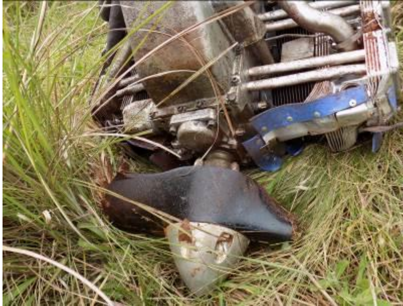
Figura 5. Daños en la hélice
