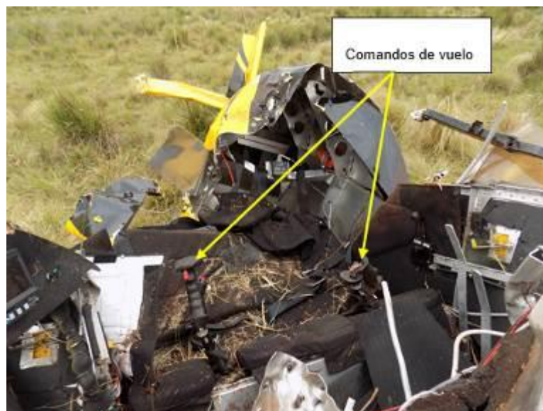
Figura 12. Estado de la cabina al momento de la llegada de los investigadores de la JST al lugar del accidente, vista de frente.
