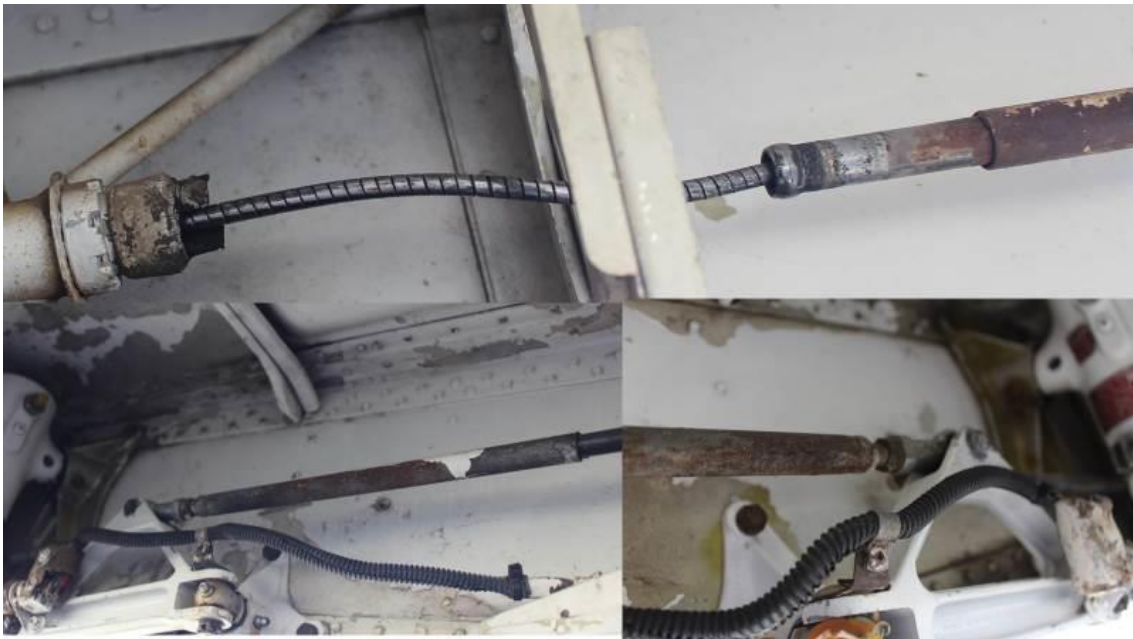
Figura 6. Oxidación y restos de pintura sobre el push-pull cable . Fuente: investigación JST
