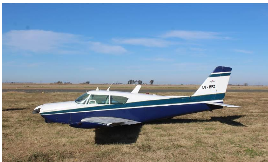
Figura 1. El LV-HFZ luego del aterrizaje con el tren retraído. Fuente: investigación JST
