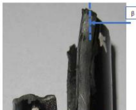
Imagen N°5 – Zonas seleccionadas para estudio metalográfico Secciones \alpha y \beta
