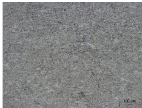
Imagen N°19 – Microestructura martensítica del material AISI 4130 (200X)
