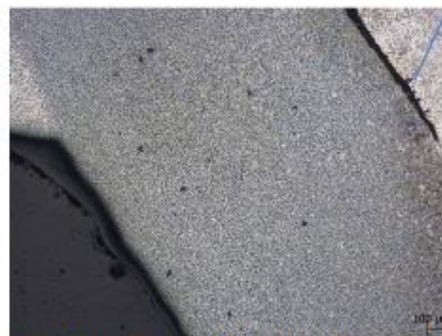
Imagen N°23 – Unión soldada del conjunto "B" (100X) Defectos internos en soldadura (falta de fusión) Corte metalográfico sobre la soldadura ubicada en la horquilla
