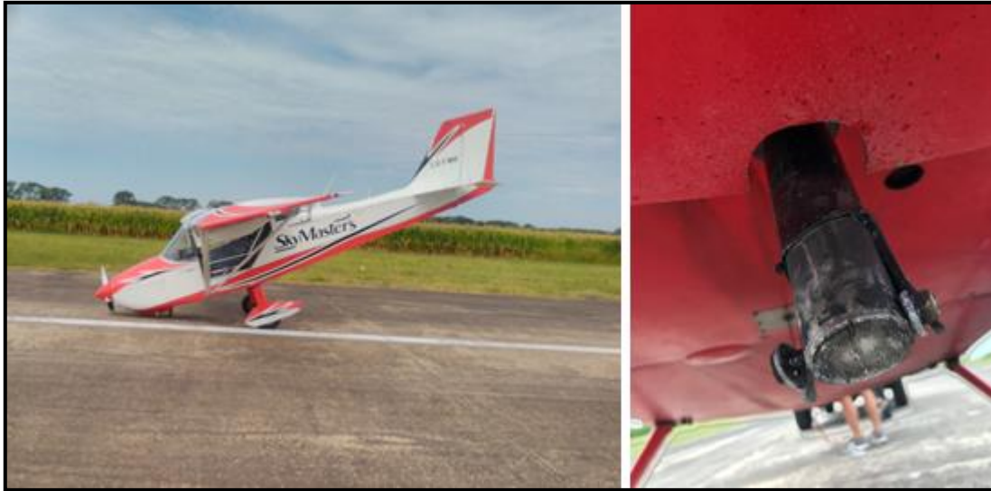
Figura 2. Daños en horquilla tren de aterrizaje de nariz
