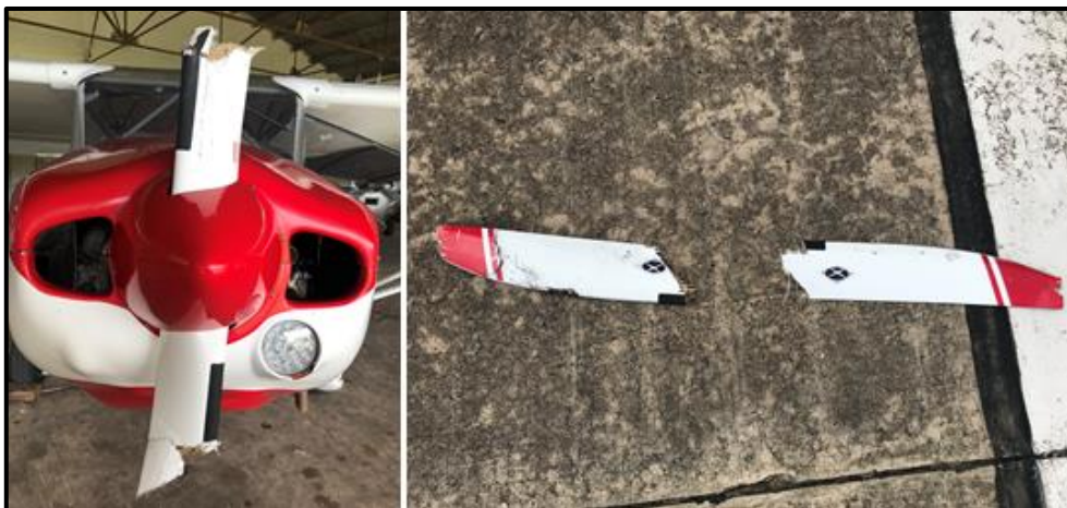
Figura 3. Daños en la hélice
