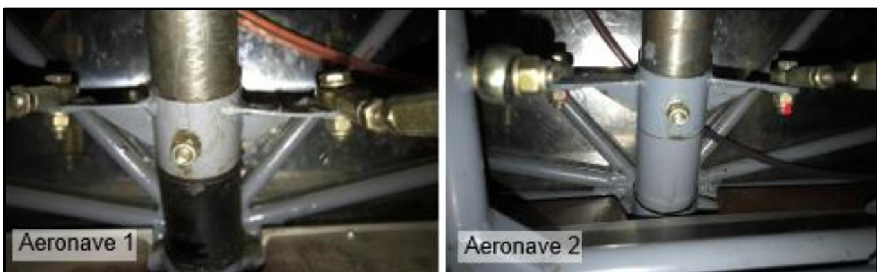
Figura 9. Cuerno de comando direccional de la rueda de tren de aterrizaje de nariz de otras aeronaves
