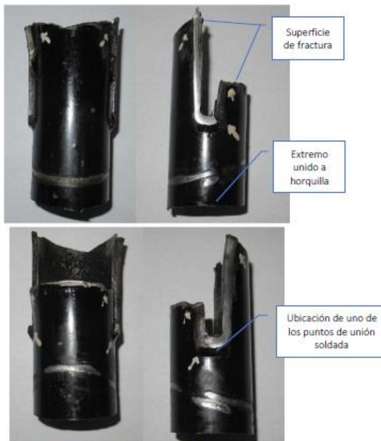
Imagen N°4 – Pieza "A" del conjunto Tren de nariz
