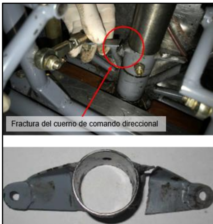
Figura 8. Imagen del cuerno de comando de dirección de la rueda de nariz
