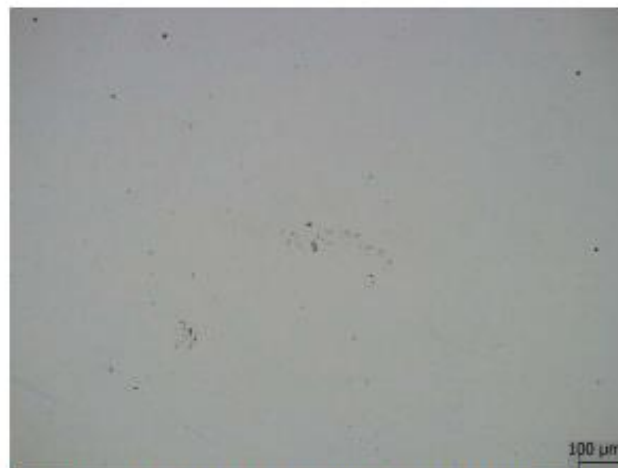
Imagen N°16 – Tenor inclusionario del material de la horquilla AISI 1006 (100X)
