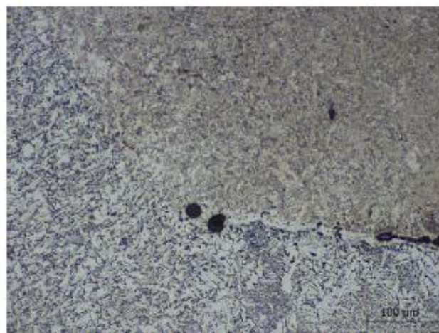
Imagen N°25 – Unión soldada del conjunto "B" (200X) Defectos internos en soldadura (porosidad y falta de fusión)
