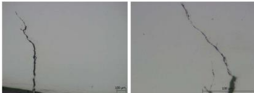
Imagen N°18 – Propagación de fisura secundaria (100X y 500X) Tamaño de fisura aproximado de 900 micrones
