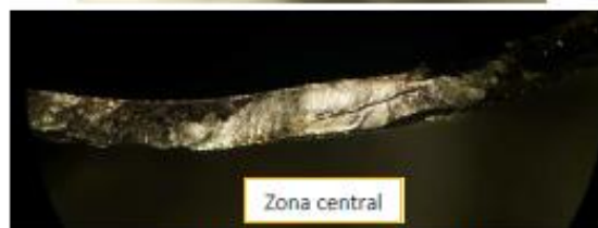
Imagen N°7 – Superficie de fractura
