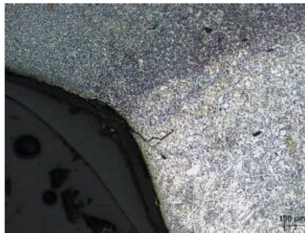
Imagen N°24 – Unión soldada del conjunto "B" (100X) Defectos internos en soldadura (fisura)
