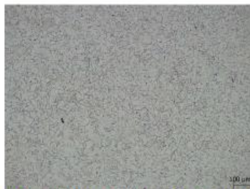
Imagen N°20 – Microestructura ferrítica con pequeñas cantidades de perlita en material AISI 1006 (100X)
