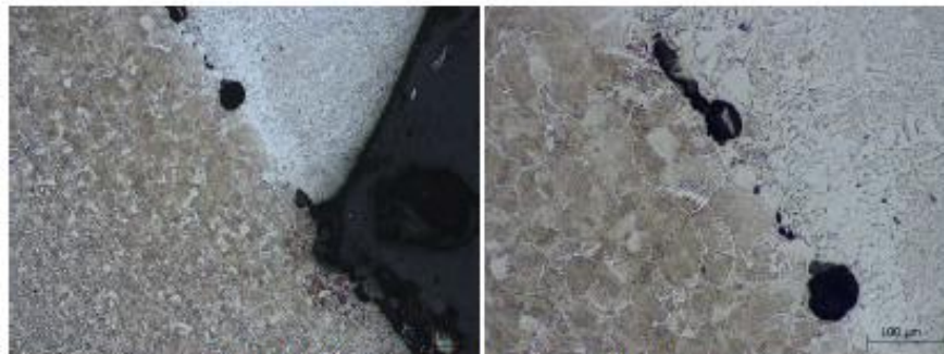
Imagen N°22 – Unión soldada del conjunto "B" (100X y 200X) Defectos internos en soldadura (porosidad) Corte metalográfico sobre la soldadura ubicada en la horquilla
