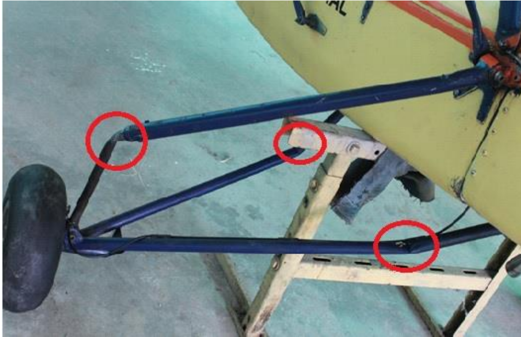
Figura 3. Imagen de los daños sufridos por el tren de aterrizaje derecho
