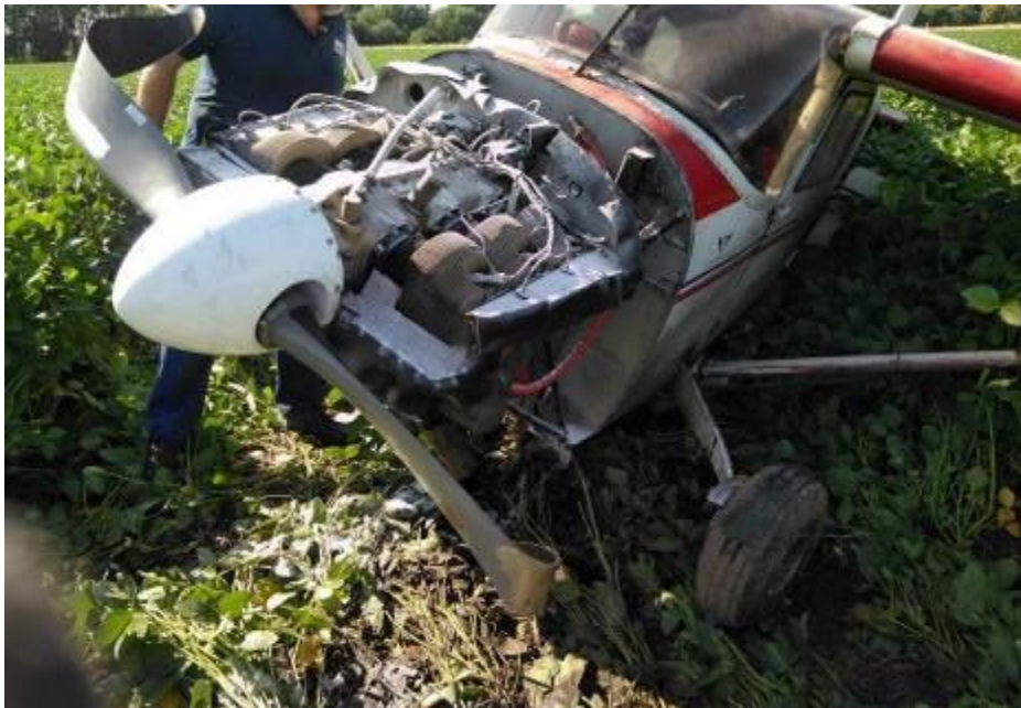
Figura 3. Retiro de la capota durante la inspección
