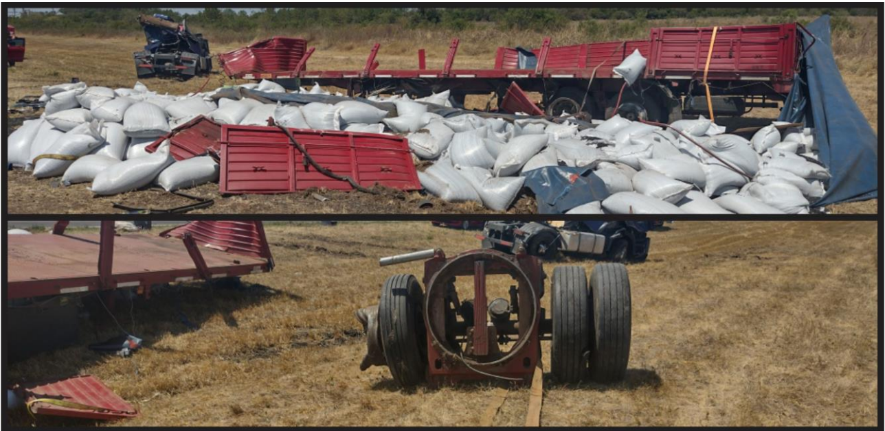
Figura 13. Las imágenes muestran la posición a la que fue movido el semirremolque del Vehículo 1. A su lado fueron depositados los restos del eje levadizo. Fuente: JST, 2022.
