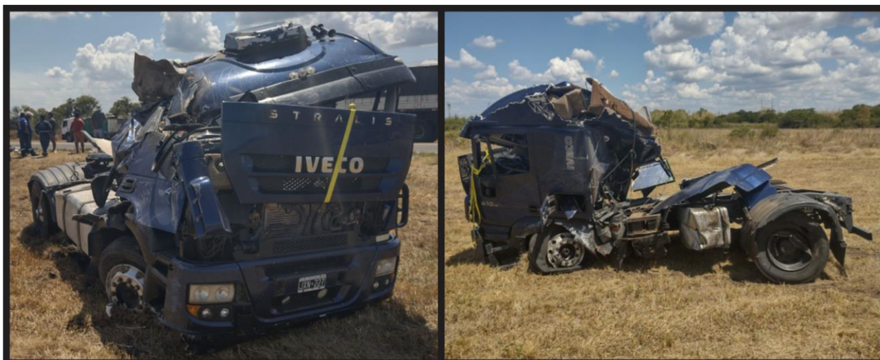
Figura 16. Daños en la unidad tractora del Vehículo 1. Fuente: JST, 2022.
