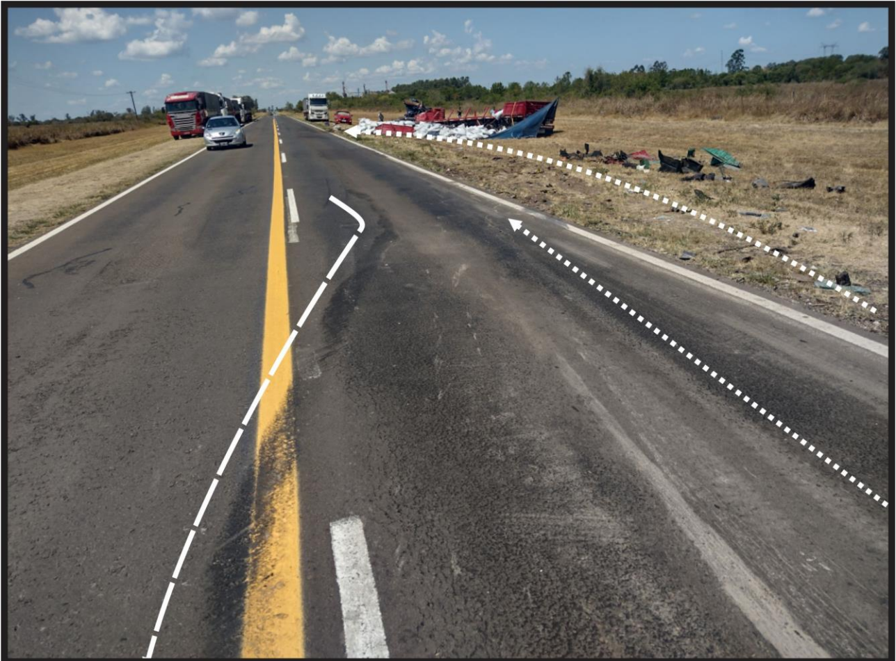
Figura 10. Vista del lugar de la vía donde se produjo el impacto, a partir de donde el Vehículo 2 produjo la marca de neumático señalada con línea discontinua. Al margen sur de la calzada se aprecian las marcas de neumático del semirremolque del Vehículo 1 y los rastros que produjo sobre el terreno aledaño, indicados con línea punteada. Fuente: JST, 2022.
