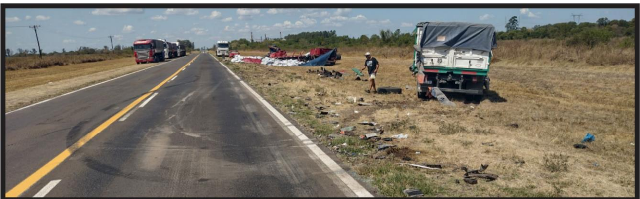
Figura 7. Sector de la calzada donde originalmente se detuvo el Vehículo 2 y produjo marcas curvas de neumático. Luego el camión fue retirado hasta la posición visible en la imagen. Fuente: JST, 2022.
