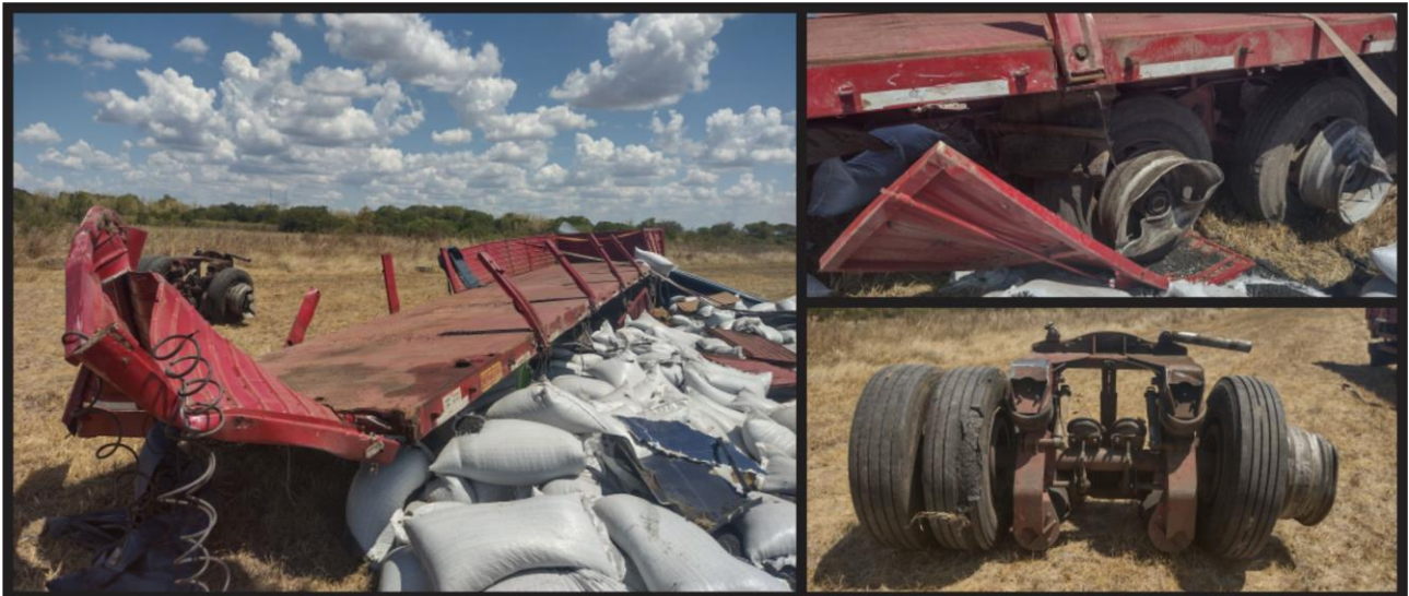
Figura 17. Daños en el semirremolque del Vehículo 1. Fuente: JST, 2022.
