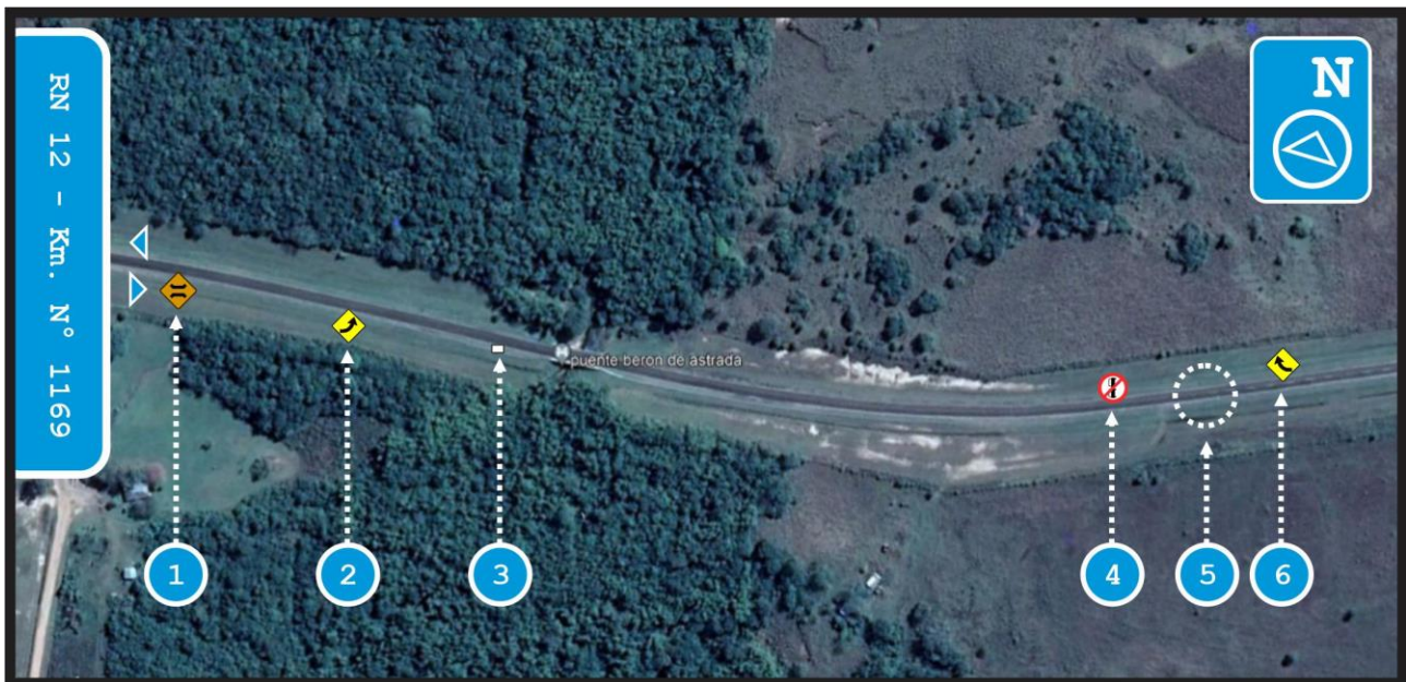
Figura 2. Captura de imagen satelital de la ubicación del suceso, cuyas referencias indican sobre la vía, de izquierda a derecha: 1) Posición de la señal preventiva de puente, 2) Posición de la señal preventiva de curva a la izquierda, 3) Posición de la señal informativa del kilómetro 1169, 4) Posición de la señal reglamentaria de prohibición de adelantamiento, 5) Lugar de ocurrencia del impacto entre los vehículos, y 6) Posición de la señal preventiva de curva a la derecha. Fuente: Google, 2022.
