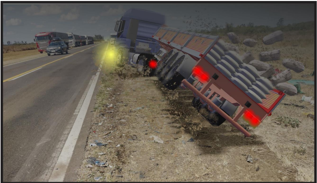
Figura 22. En la imagen se puede ver la trayectoria de despiste posimpacto descrita por el Vehículo 1, el cual comenzó a volcar sobre el terreno. Fuente: JST, 2022.
