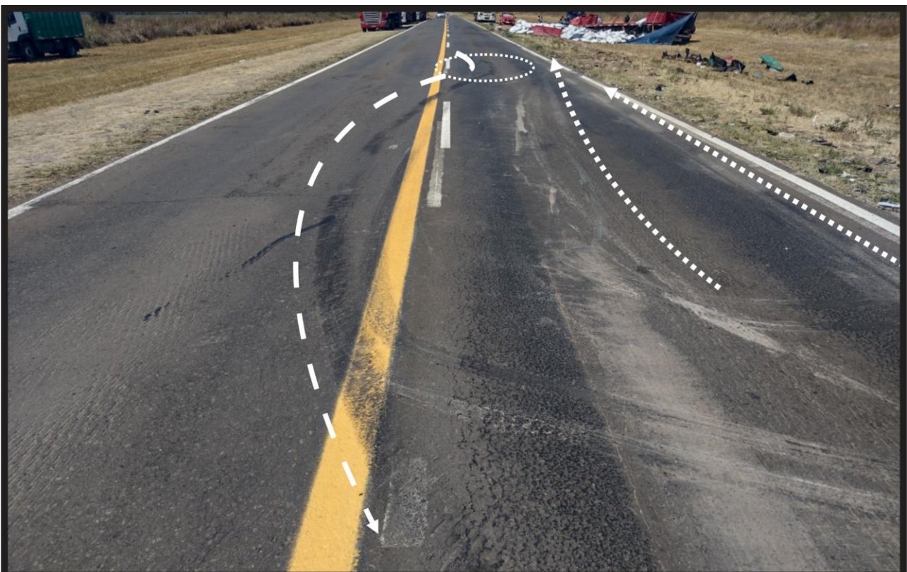
Figura 9. Vista de las marcas de neumático posimpacto producidas por el Vehículo 1 indicada mediante línea punteada, y del Vehículo 2, señaladas con línea discontinua, con relación al punto de impacto referenciado mediante un círculo. Fuente: JST, 2022.
