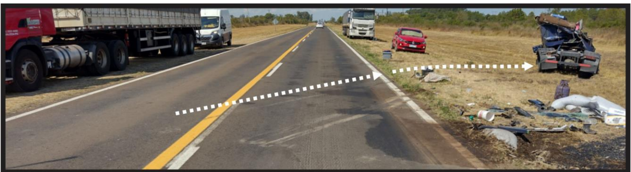
Figura 14. La imagen muestra las marcas de arrastre generadas por el Vehículo 1 sobre la calzada y terreno aledaño al ser retirado de su posición final original hasta el lugar visible en la fotografía. Fuente: JST, 2022.
