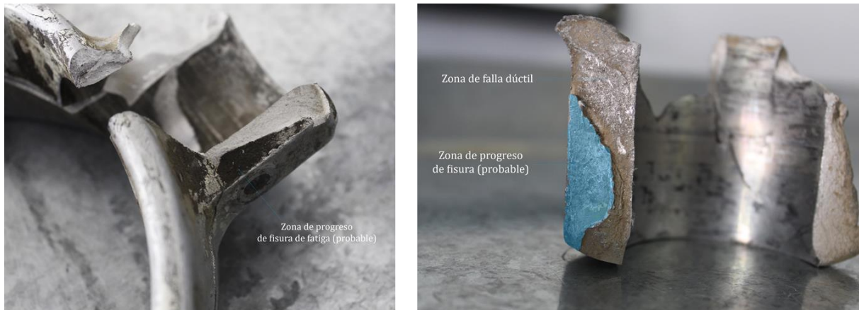
Figura 3. Probable fisura preexistente en la horquilla del tren de nariz
