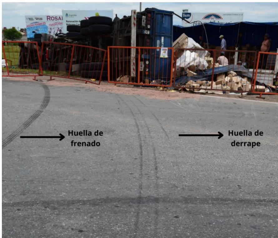
Figura 8. Huellas de frenado y de derrape en el despiste del vehículo. Fuente JST, 2022
