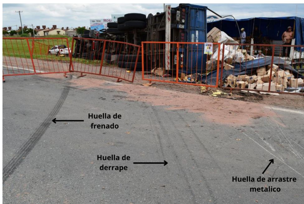
Figura 9. Huellas correspondientes con el vuelco y posición final del vehículo. Fuente JST, 2022
