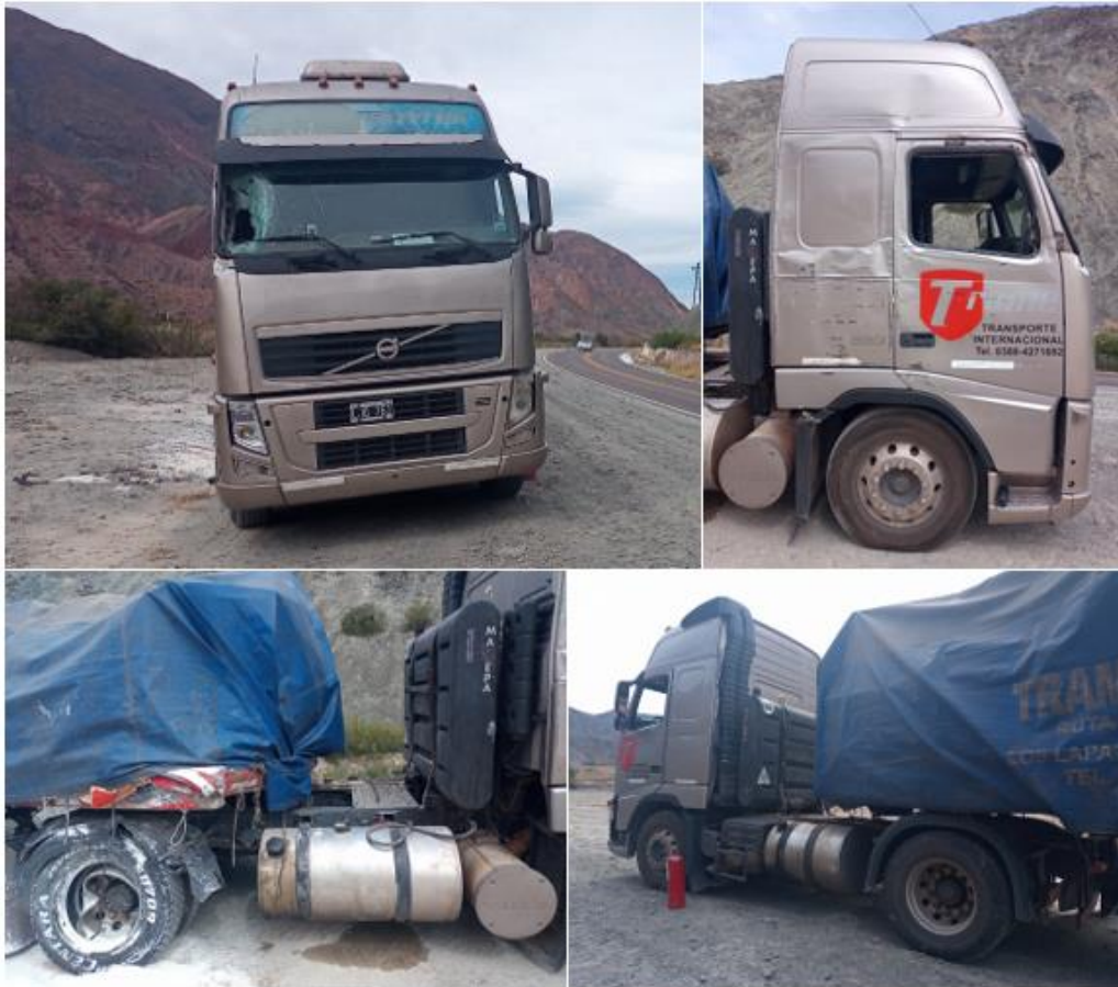
Figura 12. Estado del camión tractor del Vehículo 1 luego del accidente. Fuente: JST, 2022
