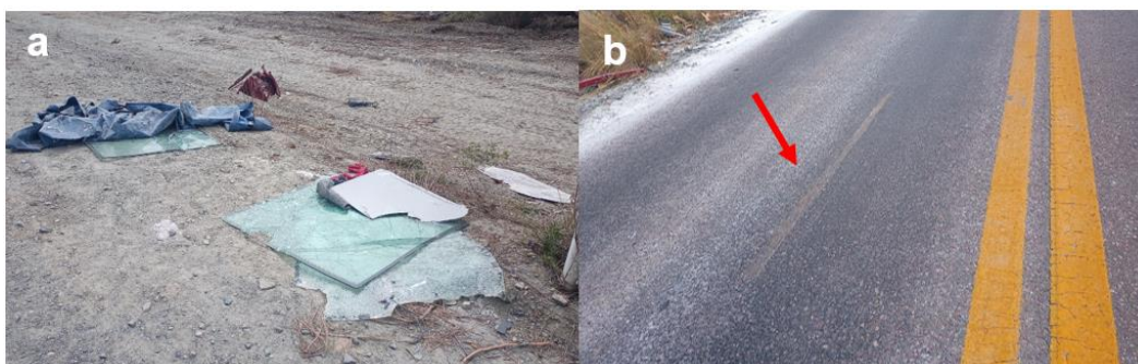
Figura 20. Restos desprendidos del ómnibus (a). Huella de efracción sobre el carril norte-sur demarcada por una estructura metálica desprendida del semirremolque (b). Fuente: JST, 2022
