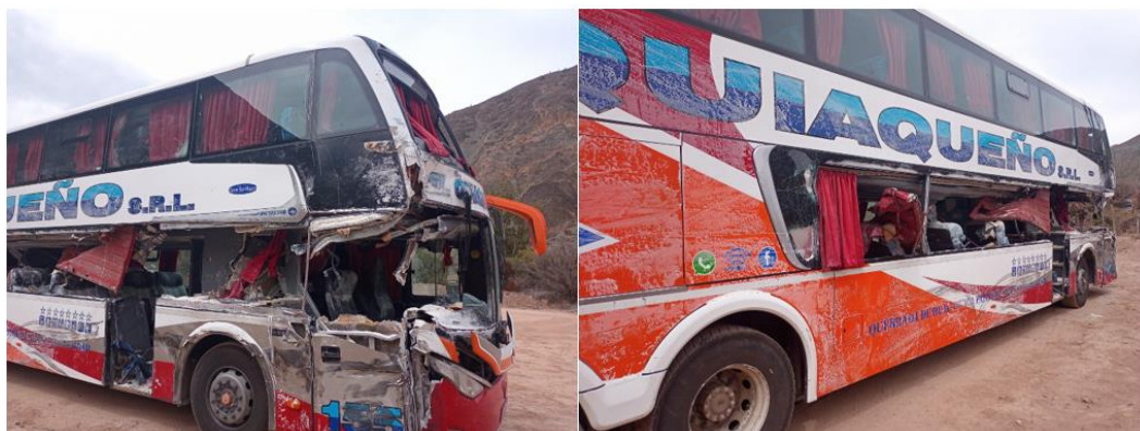
Figura 16. Vista de la zona del impacto en el lateral derecho. Fuente: JST, 2022
