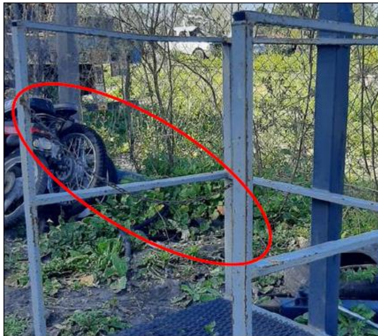
Figura 9. Cadena de cierre, frente del canasto. Fuente: Laboratorio JST, 2022
