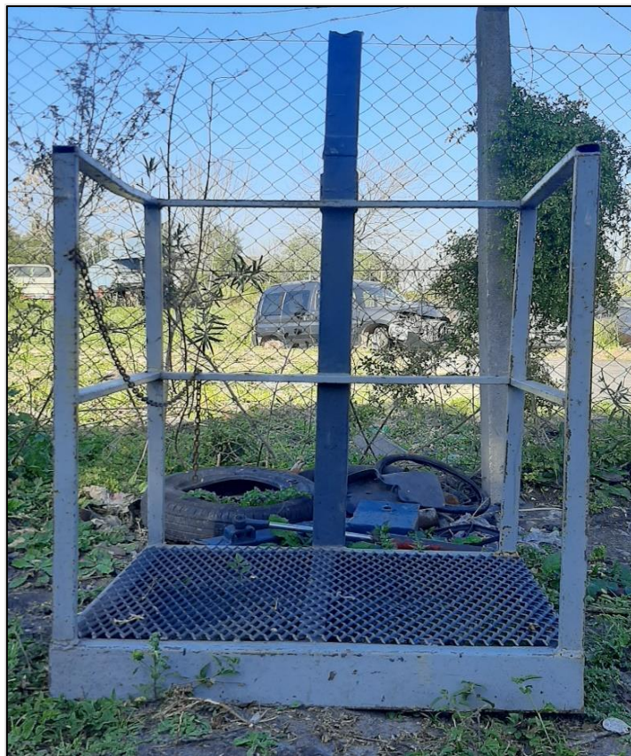
Figura 2. Canasto con el faltante que la vincula con el brazo hidráulico del camión
