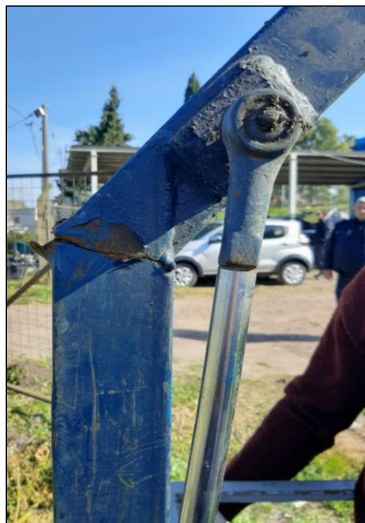
Figura 6. Zona de fractura, brazo a 45°. Fuente: Laboratorio JST, 2022
