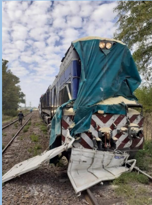
Figura 3. Daños de la locomotora posterior al suceso
