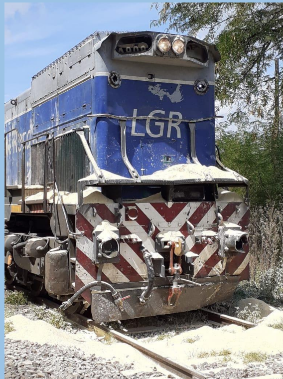
Figura 4. Daños en la locomotora después del suceso
