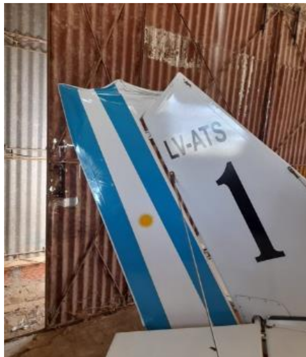
Figura 3. Estabilizador y timón de dirección con deformaciones
