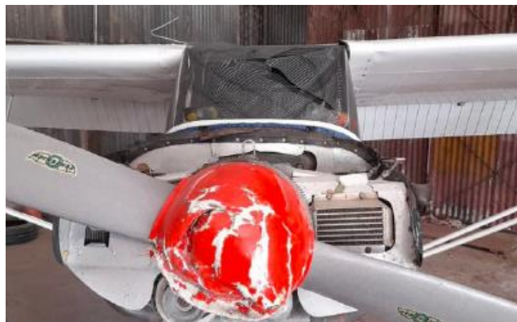
Figura 6. Daños en el parabrisas
