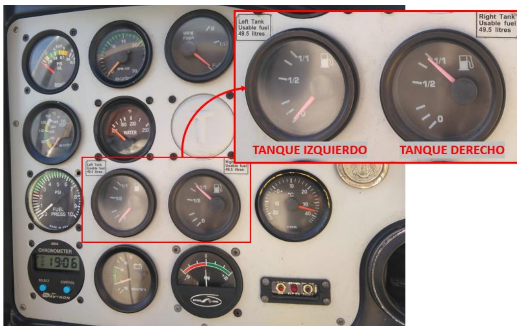
Figura 2. Indicadores de cantidad de combustible. Fuente: investigación JST
