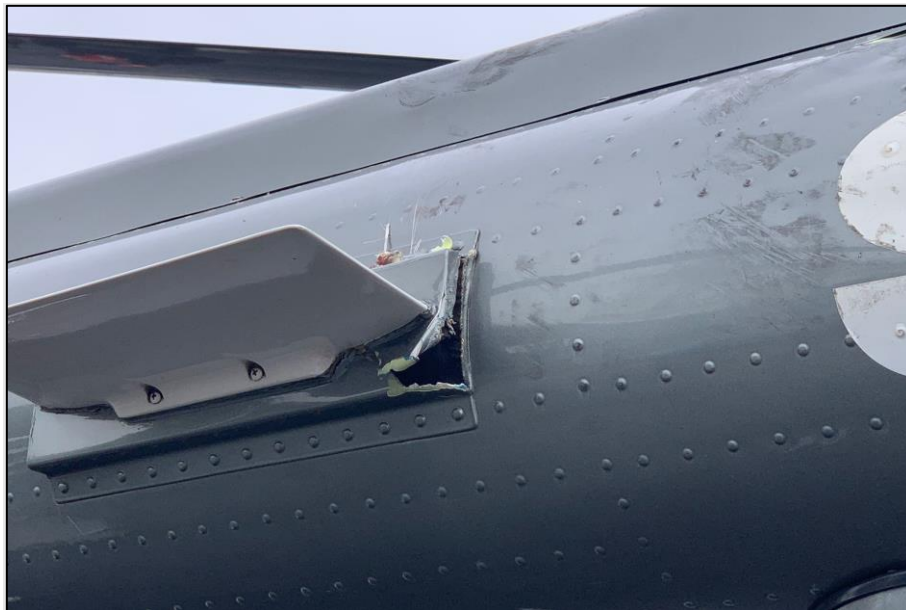
Figura 3 Daños en el cono de cola
