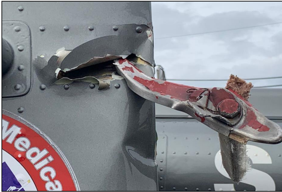
Figura 2 Daños en plano vertical del estabilizador de cola
