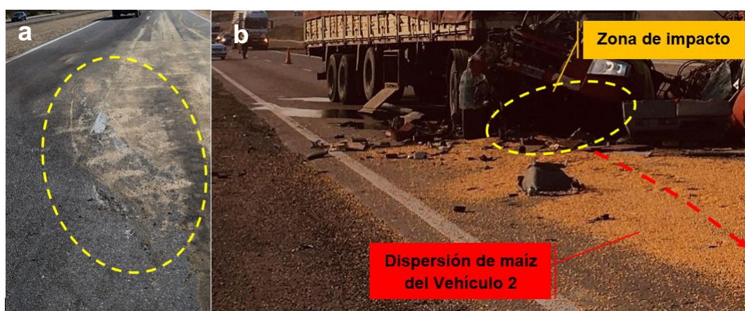
Figura 16. A la derecha: huellas de efracción dejadas por los vehículos durante la colisión. A la izquierda: zona de impacto y el inicio de la dispersión de la carga del Vehículo 2. Fuente: JST, 2022
