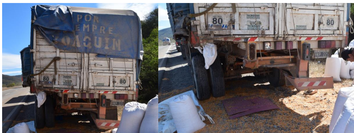
Figura 11. Daños constatados en el acoplado del Vehículo 2. Fuente: JST, 2022
