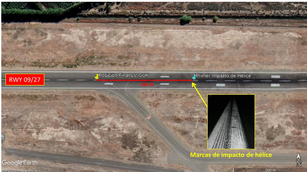
Figura 2. Trayectoria y posición final de la aeronave
