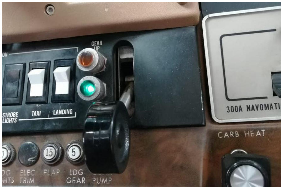
Figura 6. Luz de color verde indicadora de la extensión del tren de aterrizaje
