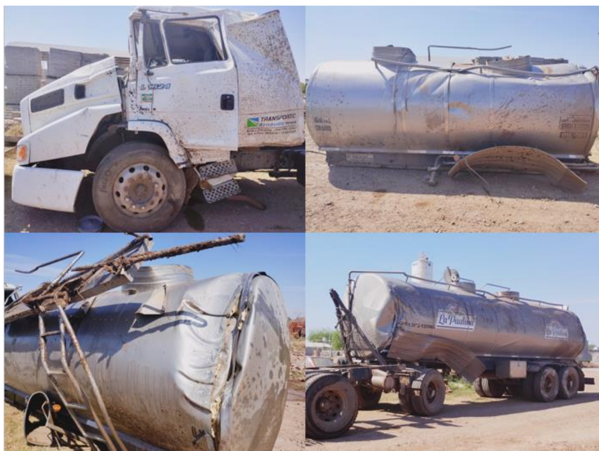
Figura 9. Daños constatados en el Vehículo 1. Fuente: JST, 2022
