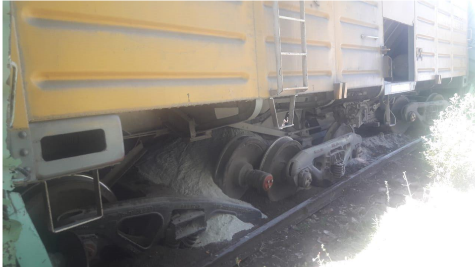
Figura 11. Pérdida de carga en vagón 637363 (posición 28). Fuente: Investigadores JST
