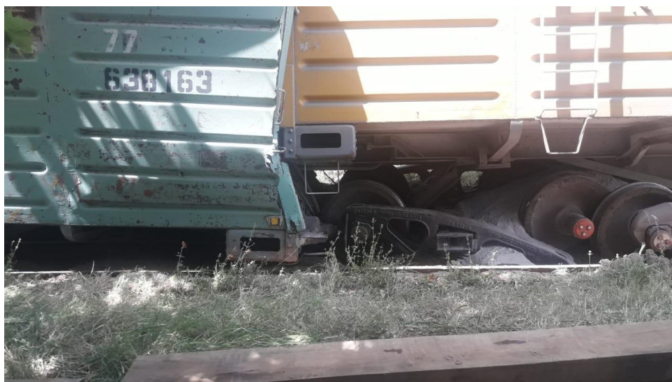
Figura 10. Daños en vagón 638163 (posición 27) producido por colisión con vagón 637363. Fuente: Investigadores JST
