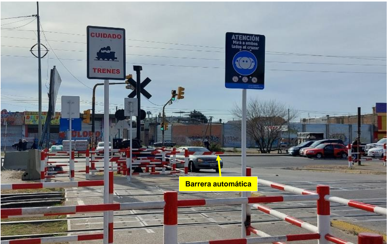
Figura 13. Barrera automática del paso a nivel Del Tejar. Fuente: investigadores JST, 2021
