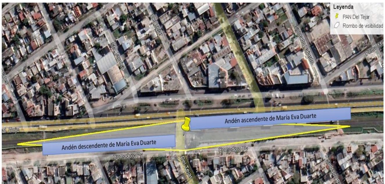
Figura 11. Rombo de visibilidad del paso a nivel Del Tejar. Fuente: Google Earth Pro, anotaciones JST, 2021
