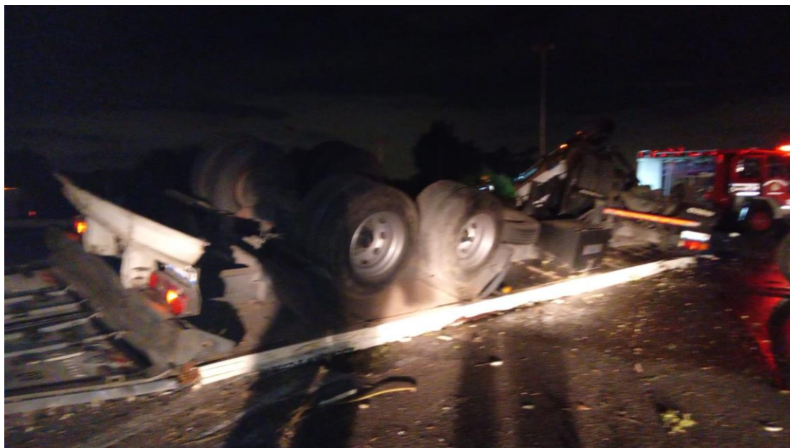
Figura 8. Daños en la totalidad de los paneles isotérmicos del semirremolque. Fuente: Corredores Viales, 2022
