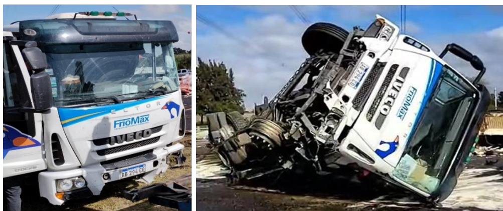
Figura 7. Daños en el sector frontal y lateral izquierdo de la unidad a causa del impacto con las barreras de contención y posterior vuelco. Fuente: JST y transmisión televisiva TN, 2022
