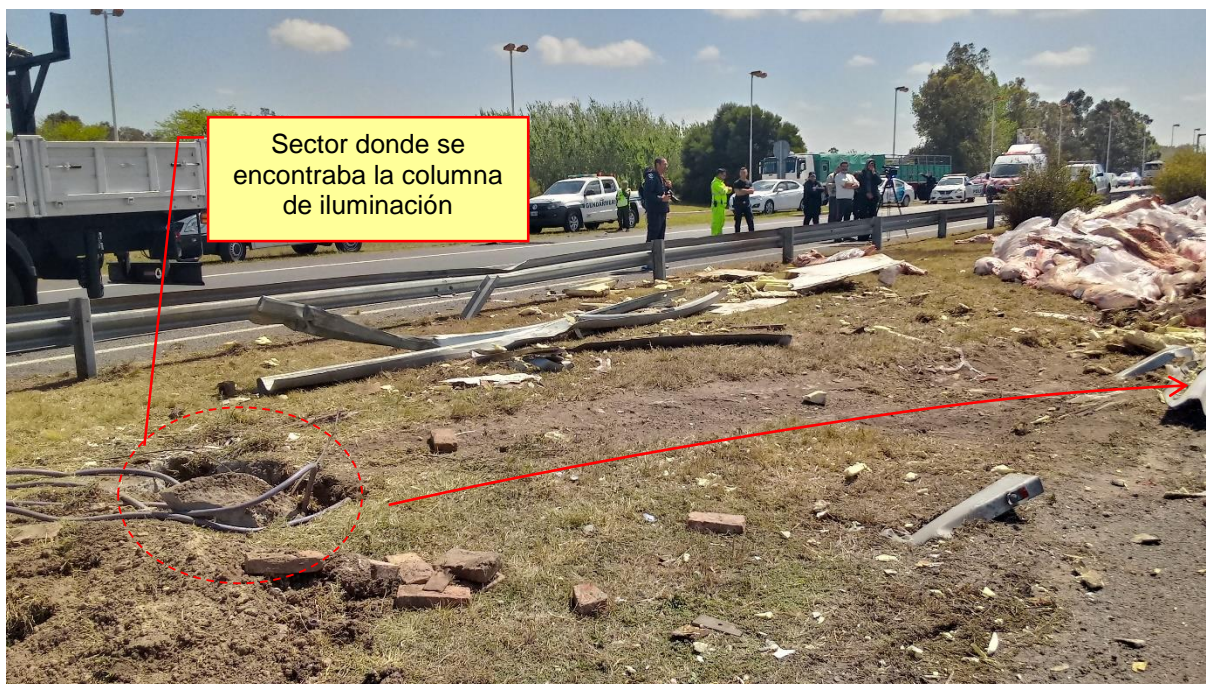
Figura 15. Remoción de tierra a causa del desprendimiento de la columna de iluminación y marcas que generó el camión con semirremolque a causa del vuelco. Fuente JST, 2022
