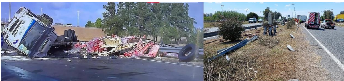
Figura 1. Posición final del camión y semirremolque. Pueden observarse la carga dispersa y daños en la infraestructura vial. Fuente: JST y transmisión televisiva C5N, 2022
