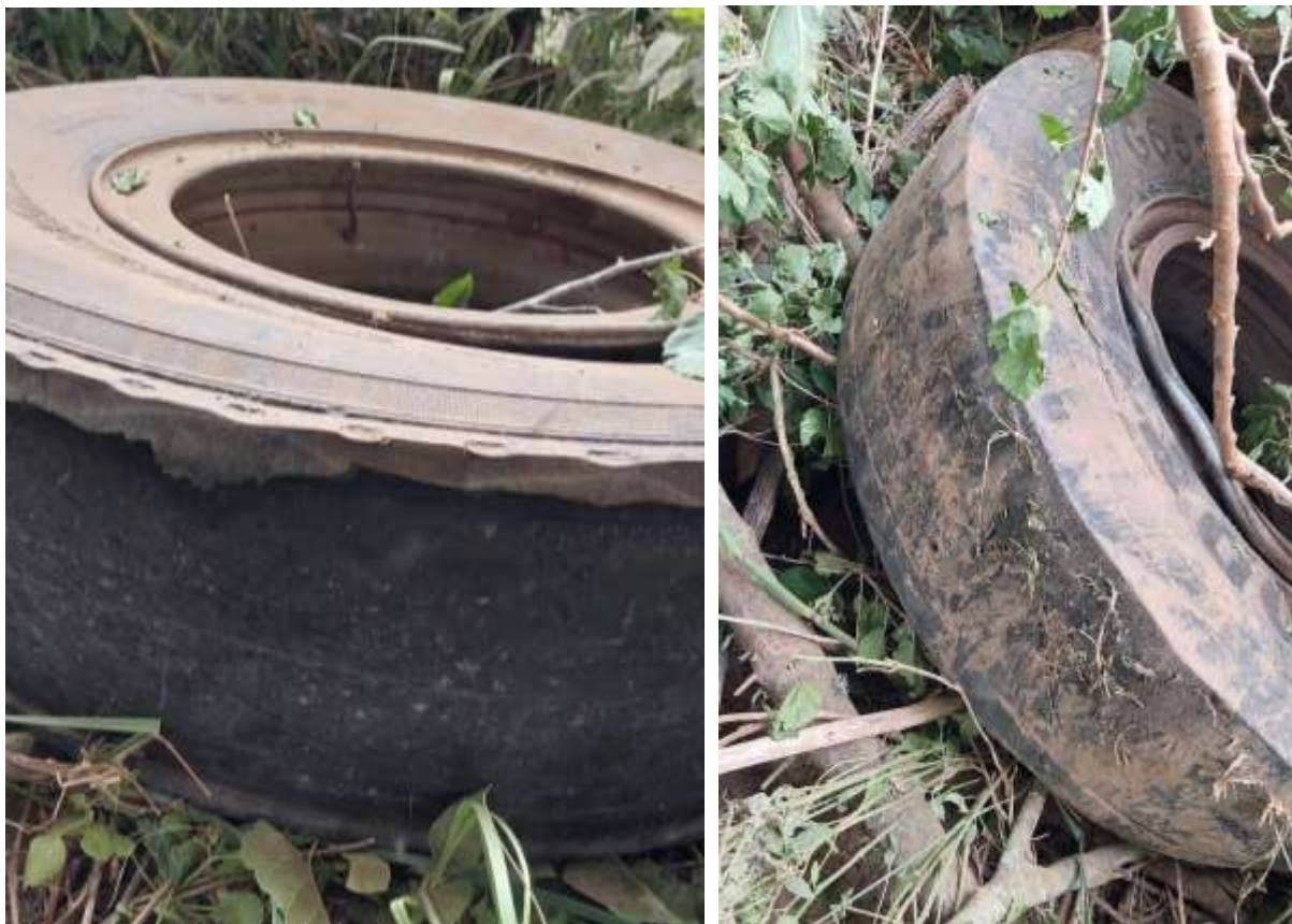
Figura 14. Pérdida de banda de rodadura y eliminación de surcos por desgaste en los neumáticos.
