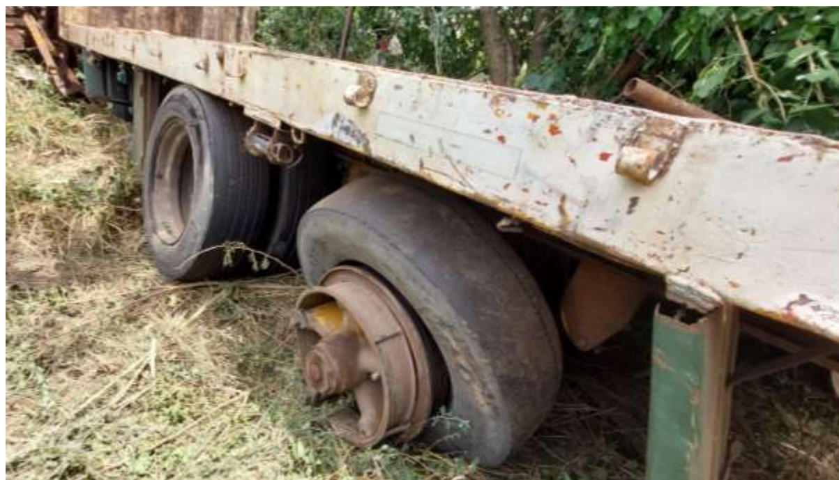
Figura 13. Desgastes de los neumáticos correspondientes al lateral izquierdo. Fuente: JST, 2022
