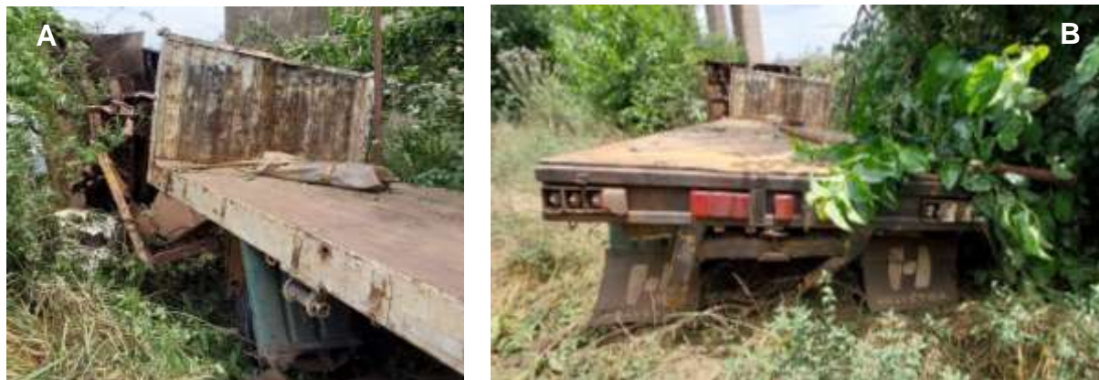
Figura 12. Pliegue de la lanza de enganche y daños en paragolpes y ópticas. Fuente: JST, 2022
