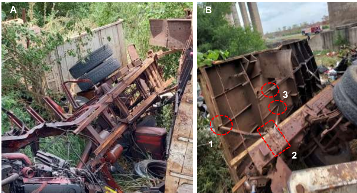
Figura 10. Listones de madera unidos a los largueros del chasis (A) y sistema de anclaje del chasis con la caja de carga (B). Fuente: JST, 2022
