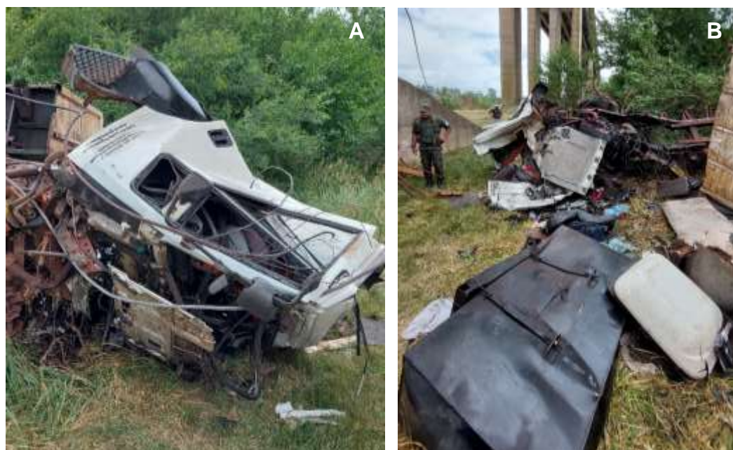
Figura 9. Daños en la cabina (A) y desprendimiento y daños de depósito de combustible, motor, caja, diferencial y chasis (B). Fuente: JST, 2022
