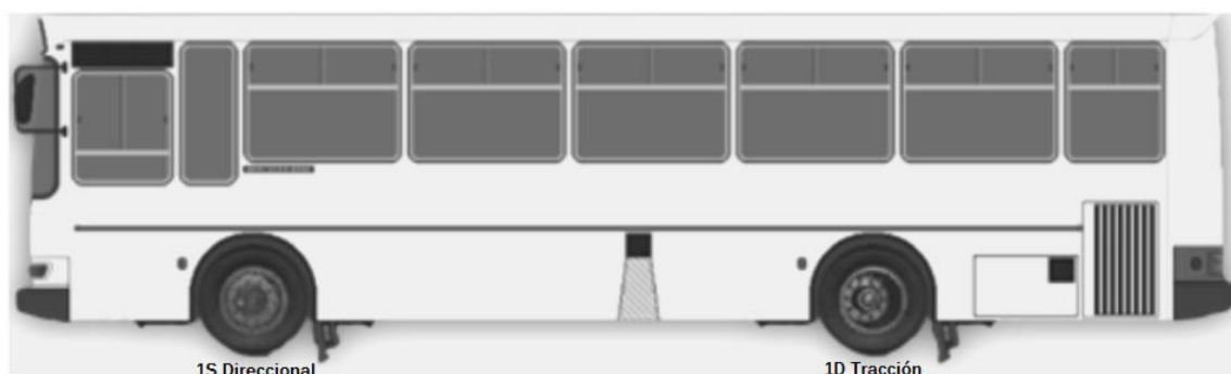
Imagen 3. Configuración de ejes, ómnibus urbano piso bajo, Jurisdicción Nacional, 2021.
