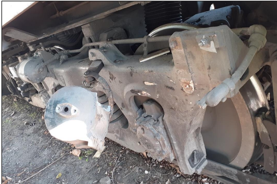
Figura 10. Daños en el cilindro de freno de la locomotora 8258. Fuente: JST, 2021
