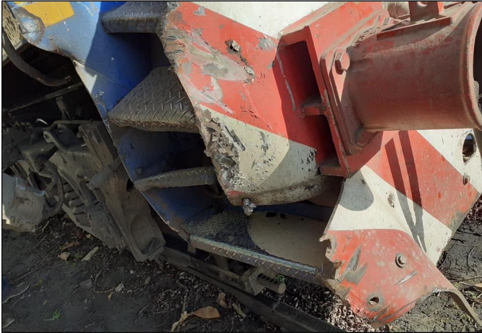
Figura 9 Daños en el arenero y en la escalera de la locomotora 8258. Fuente: JST, 2021
