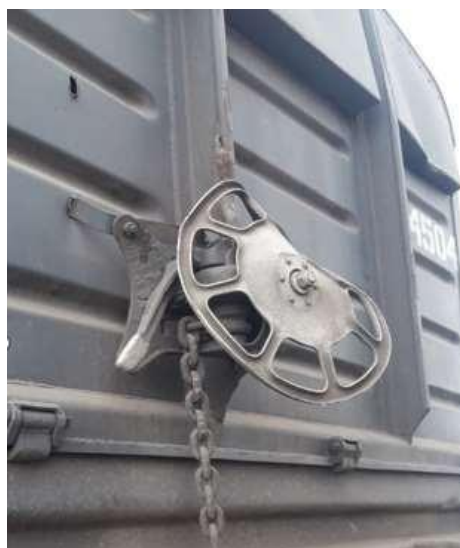
Figura 2. Daños en el accionamiento del freno de uno de los vagones involucrados en el accidente. Fuente:
