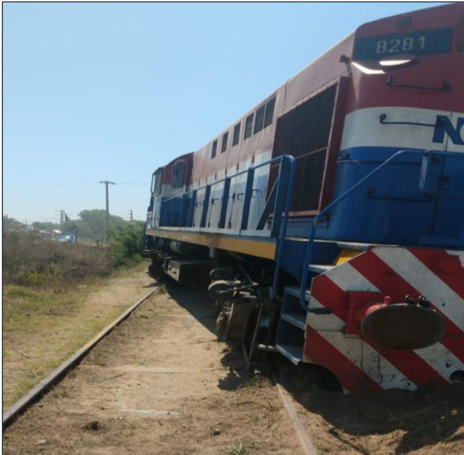
Figura 2. Ruedas del lado derecho de la locomotora en sentido de la marcha del tren en contacto con el interior del riel izquierdo. Fuente: JST, 2021
