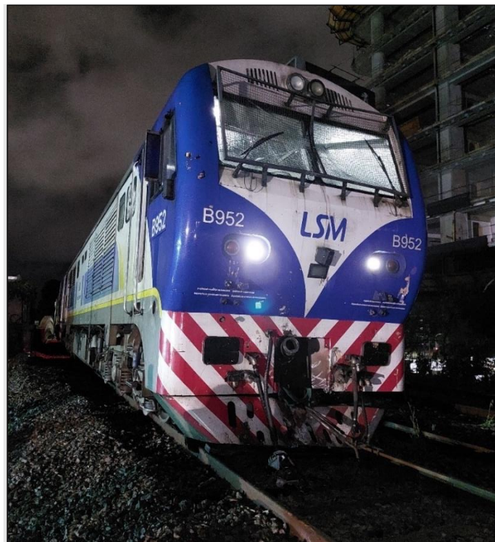
Figura 11. Daños en la locomotora B952. Fuente: JST, 2021
