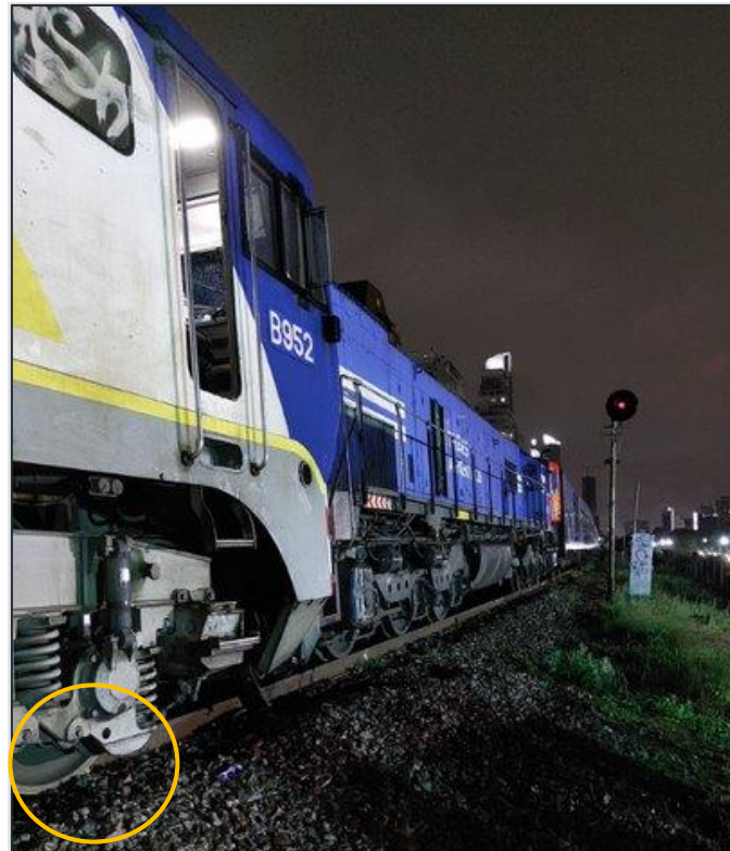
Figura 9. Imagen de la locomotora B952 con su primer eje descarrilados. Fuente: JST, 2021
