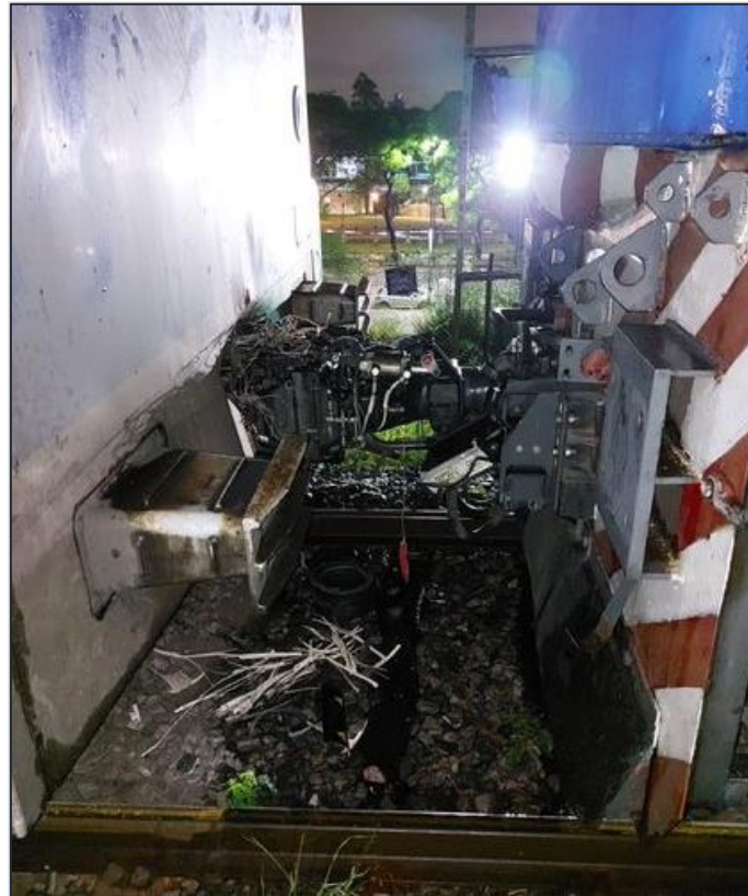
Figura 13. Daños en el enganche entre la locomotora A901 y el primer coche del tren. Fuente: JST, 2021
