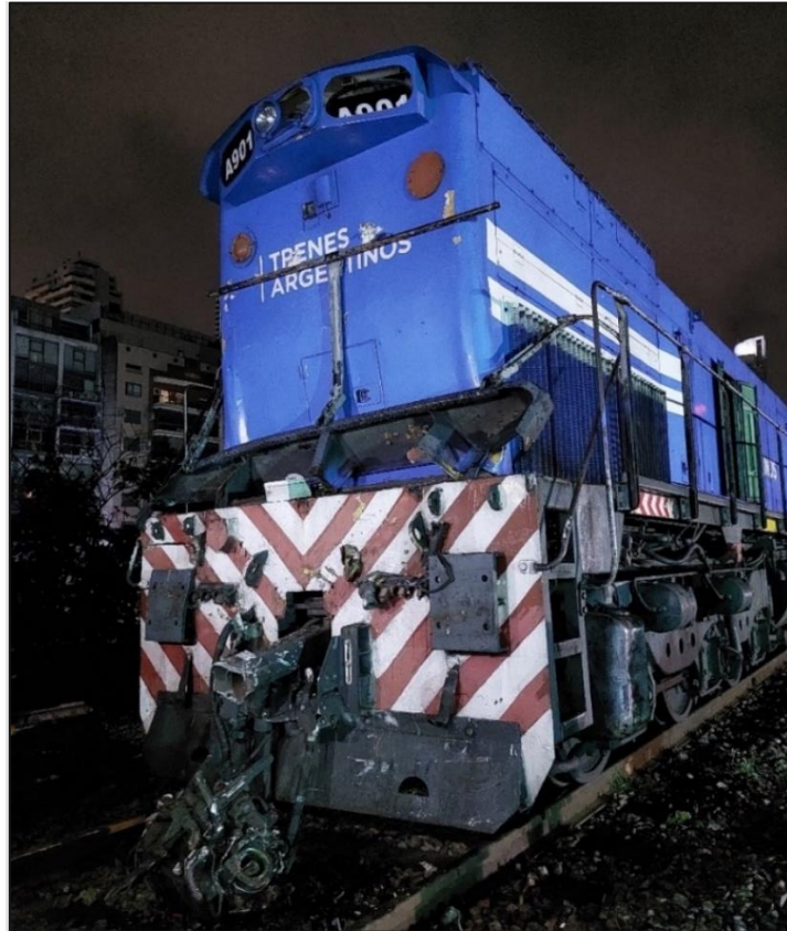
Figura 12. Daños en la locomotora A901. Fuente: JST, 2021
