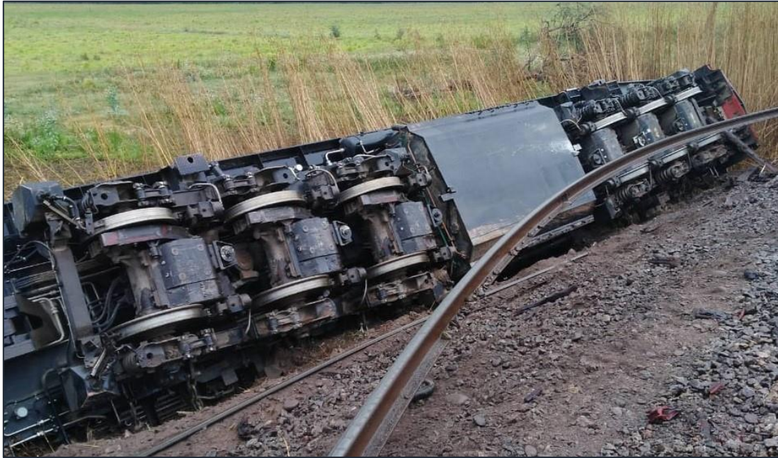
Figura 2. Locomotora volcada a la vera de la vía. Fuente: JST, 2021
