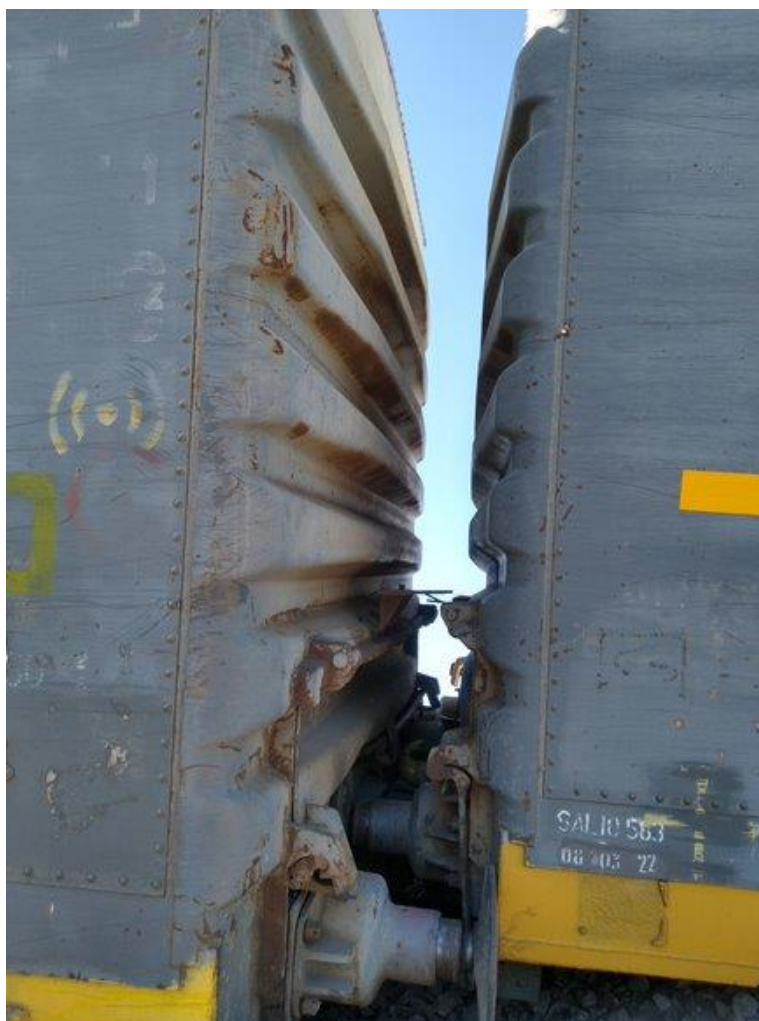
Figura 3. Daños en la caja de los vagones. Fuente: JST, 2023
