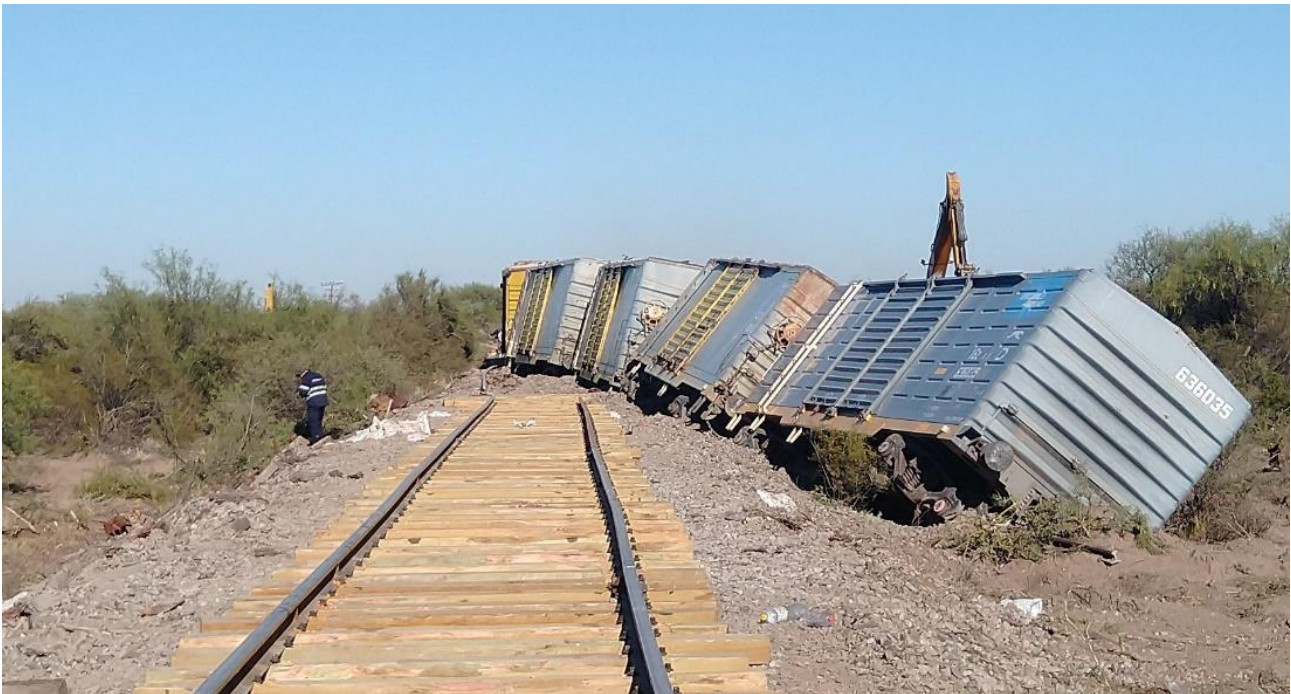
Figura 1. Vagones descarrilados y tumbados sobre el margen lateral de la vía. En la imagen se observa la parrilla de vía restaurada luego del accidente. Fuente: JST, 2023
