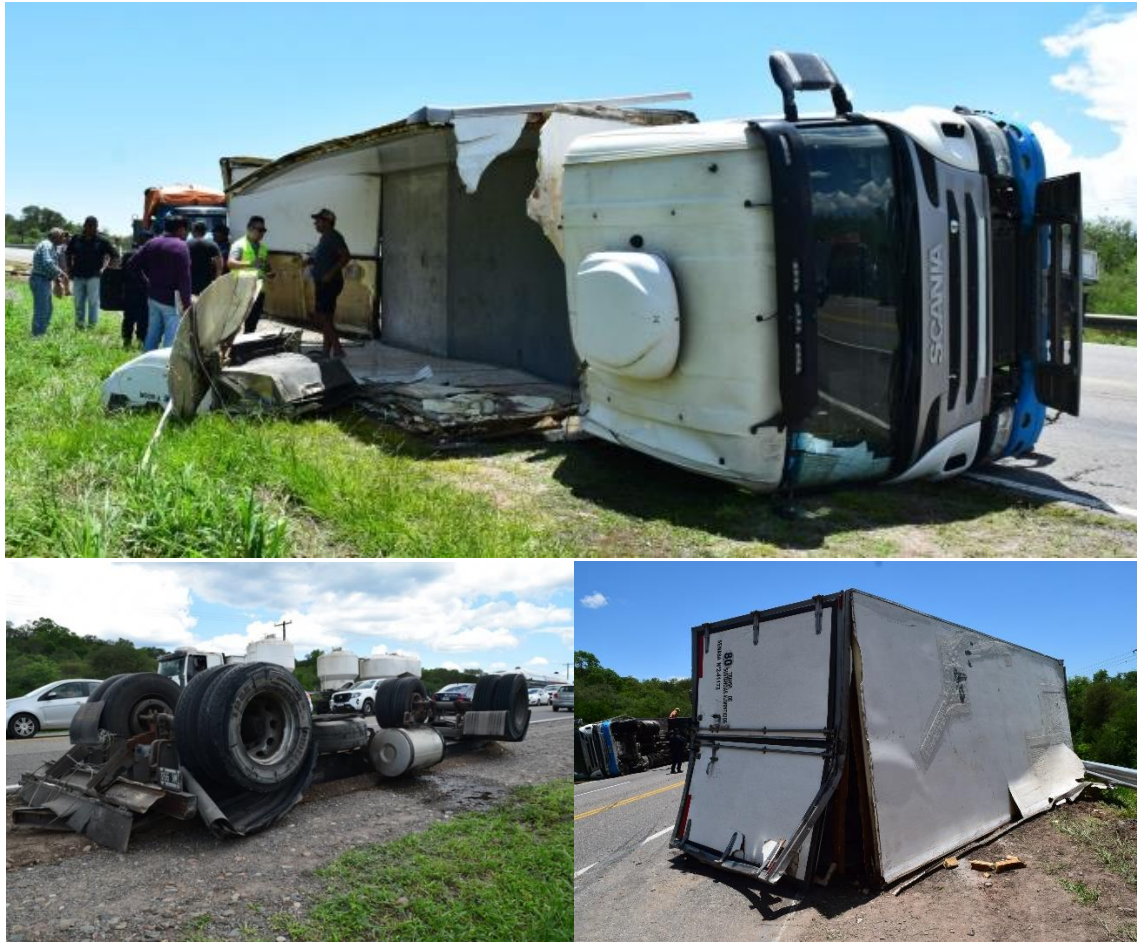
Figura 1. Posición final del camión y chasis del acoplado al momento del relevamiento (desplazados de su posición original) y de la caja del vehículo remolcado. Fuente: JST, 2023
