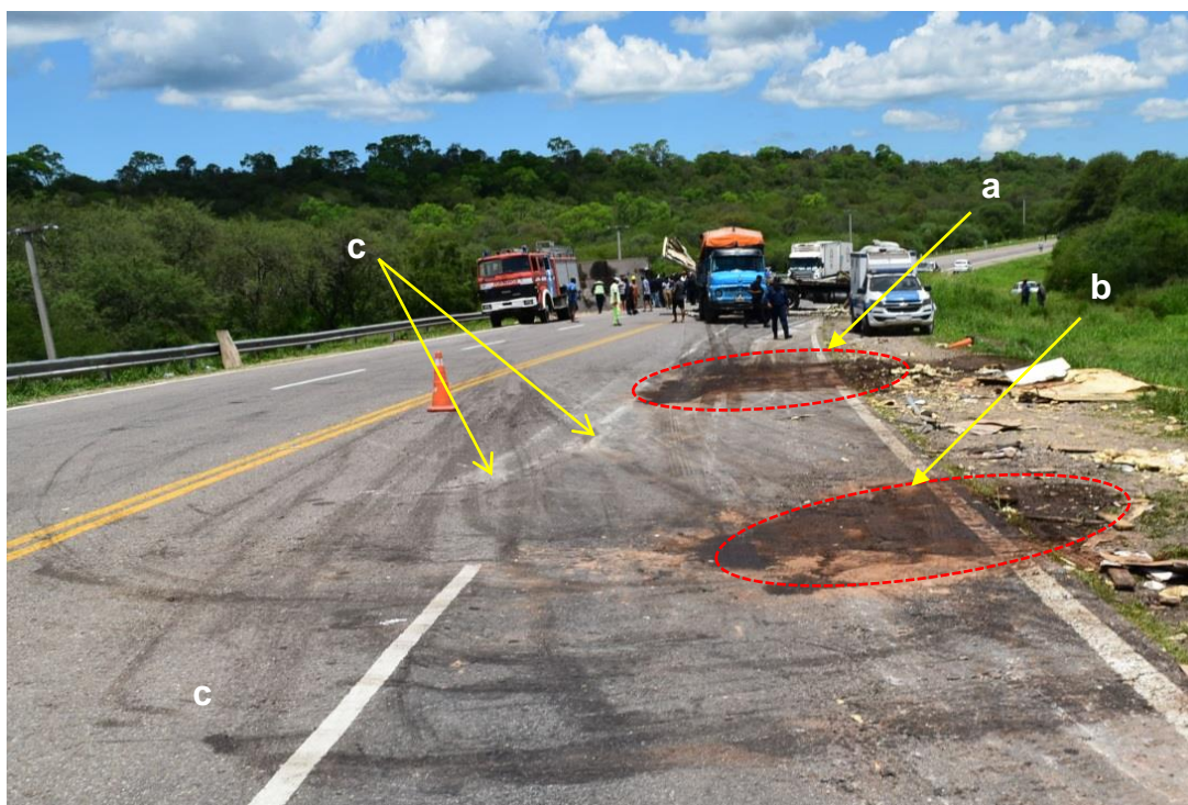
Figura 12. a) posición final del camión tractor; b) posición final del chasis del acoplado (invertido); c) huellas de efracción. Fuente: JST, 2023
