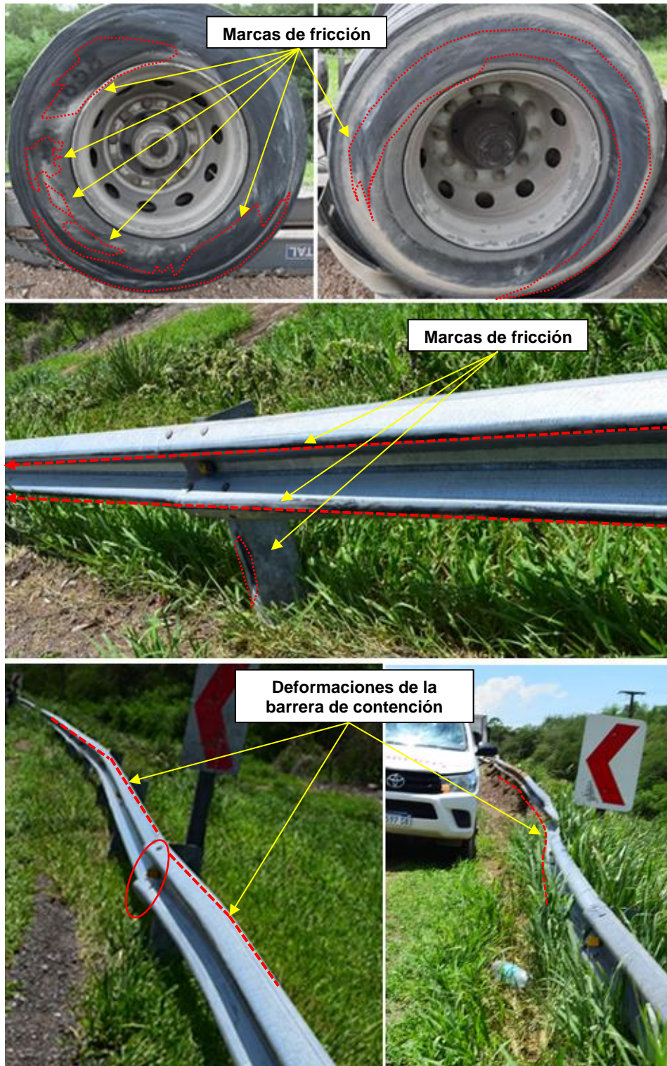
Figura 9. Marcas de fricción en los flancos derechos y exteriores de los neumáticos delanteros y traseros del acoplado y marcas de fricción y deformación en la barrera de contención lateral. Fuente: JST, 2023
