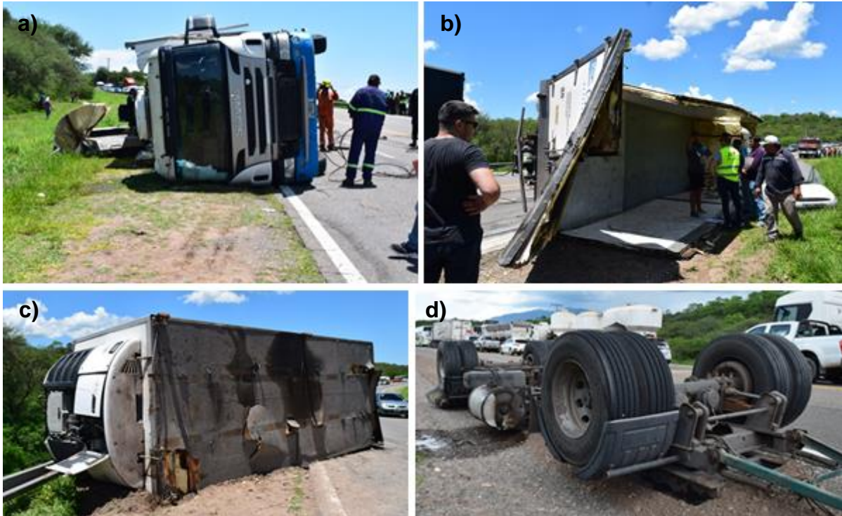
Figura 6. Daños en el vehículo 1: a y b) camión tractor y caja frigorífica; c y d) caja isotérmica y chasis del acoplado respectivamente. Fuente: JST, 2023
