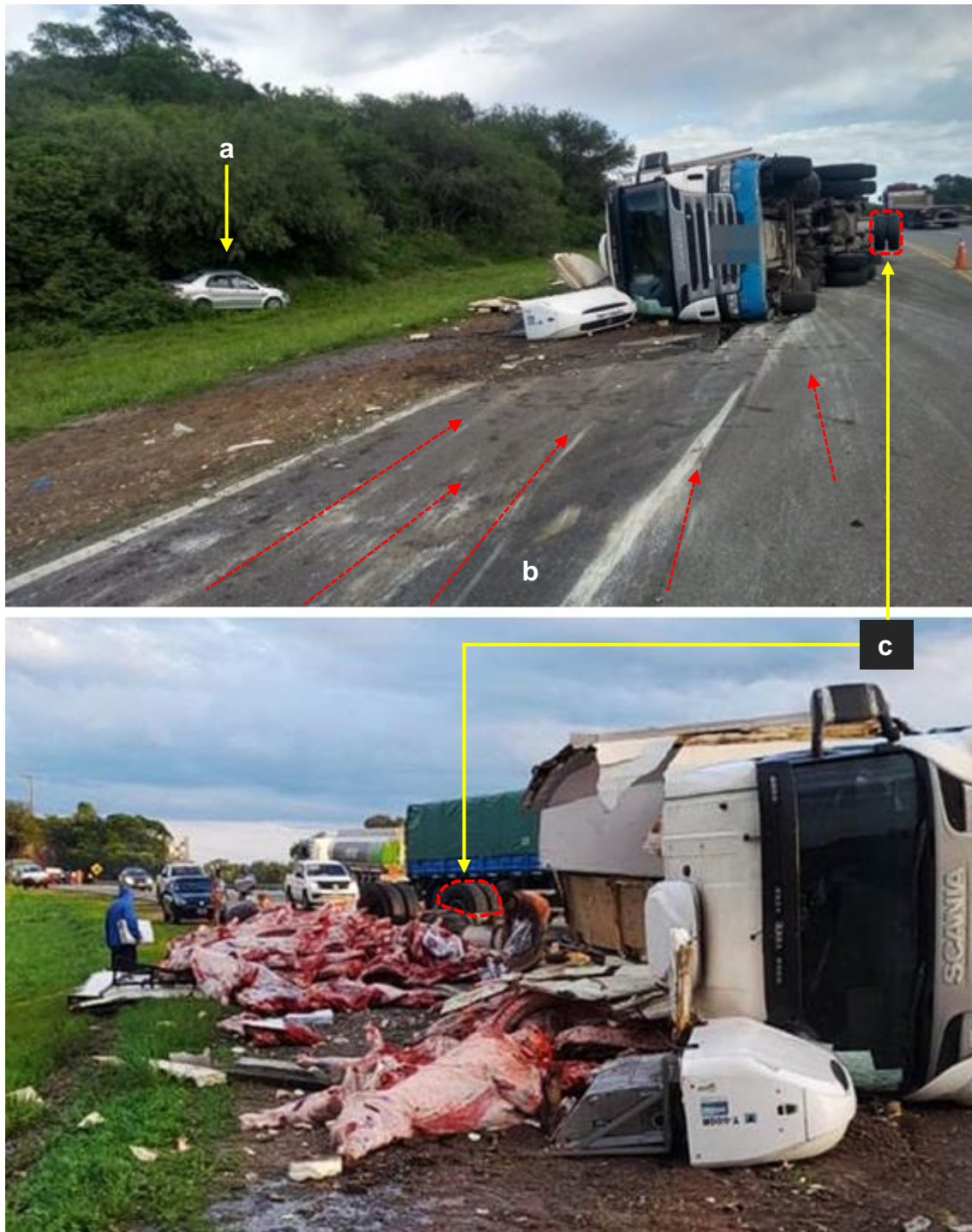
Figura 13. a) posición final del Vehículo 2; b) huellas de efracción del camión tractor; c) posición final del Vehículo 1 y ubicación de ruedas suspendidas del chasis del acoplado tras el vuelco. Fuente:
