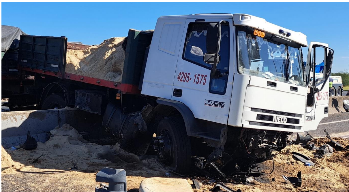
Figura 14. Daños producidos a causa del desplazamiento de la carga. Fuente: JST, 2023
