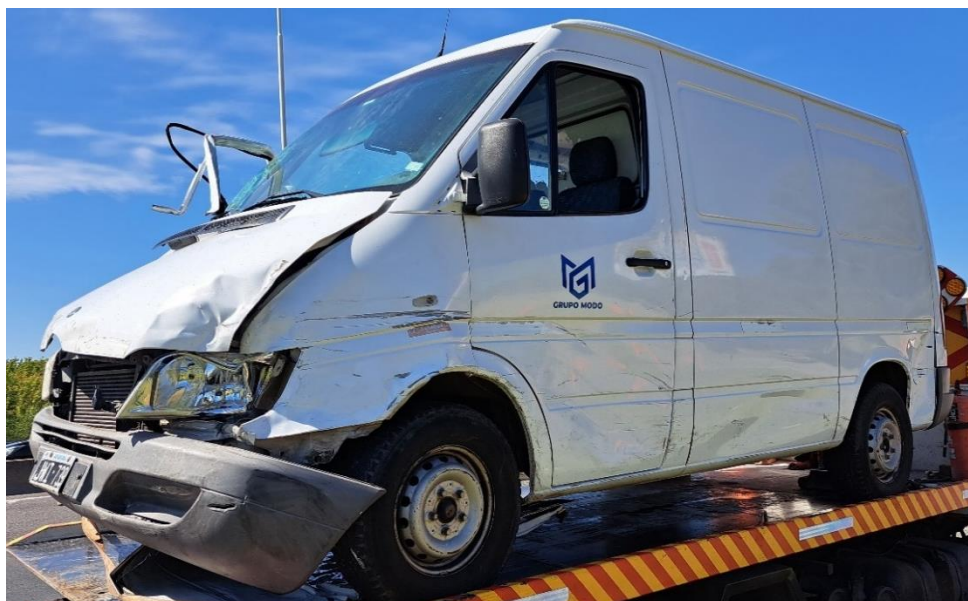
Figura 10. Daños producidos en el impacto con el Vehículo 1. Fuente: JST, 2023
