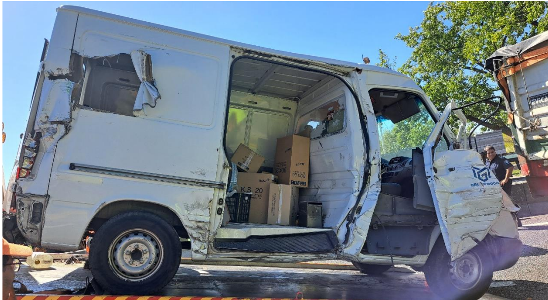
Figura 9. Daños producidos por el impacto con el Vehículo 3. Se observa que la fuerza de deformación posee un sentido desde el sector posterior hacia el sector anterior. Fuente: JST, 2023
