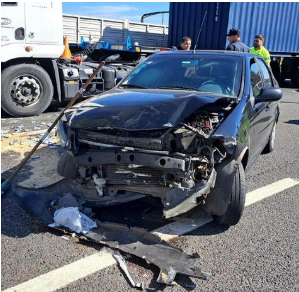
Figura 4. Daños en el sector anterior del Vehículo 1. Fuente: JST, 2023
