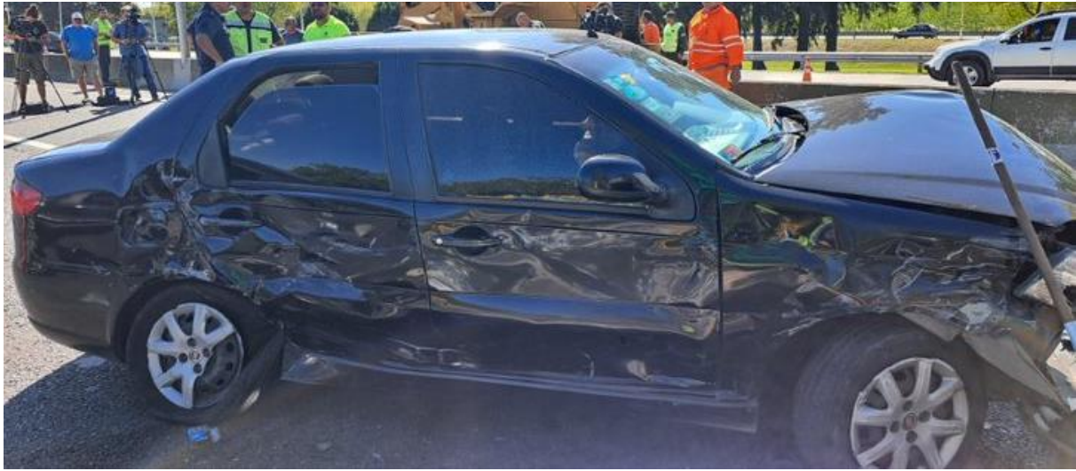
Figura 5. Daños en el sector anterior del Vehículo 1. Fuente: JST, 2023
