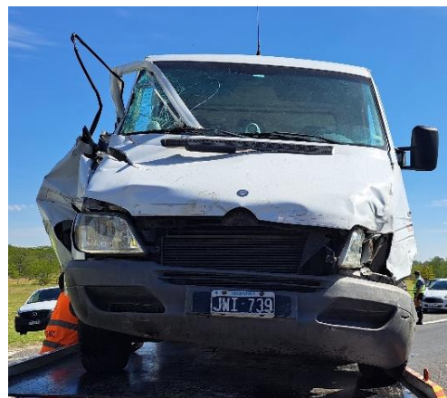
Figura 8. Daños ocasionados por las colisiones con el Vehículo 1 y el Vehículo 3. Fuente: JST, 2023
