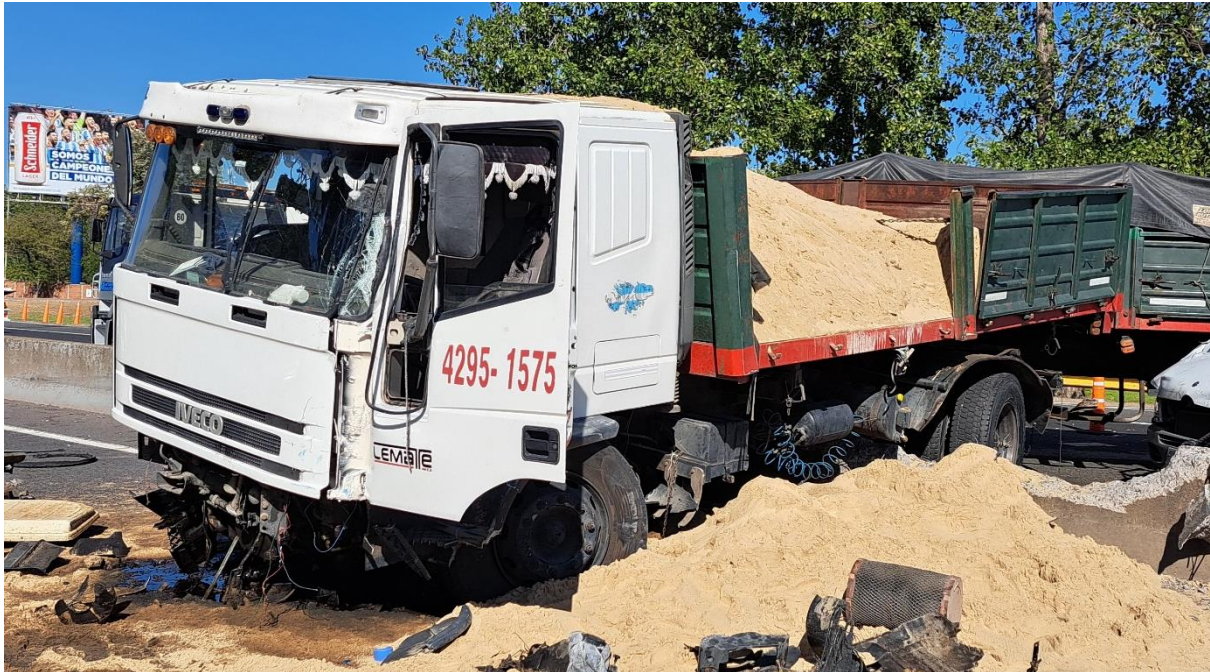
Figura 13. Daños producidos en el impacto con el Vehículo 2 y barrera de contención. Fuente: JST, 2023
