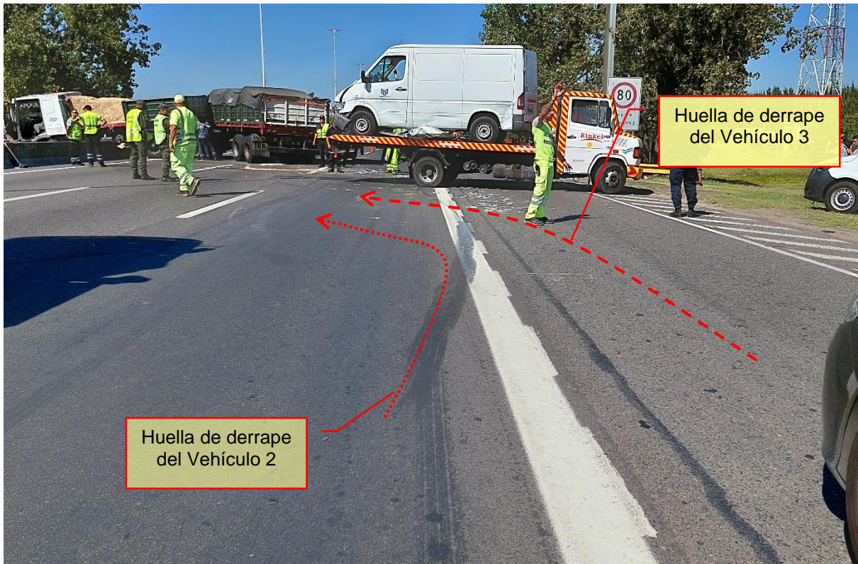
Figura 16. Inicio de las huellas de derrape posimpacto. Fuente: JST, 2023
