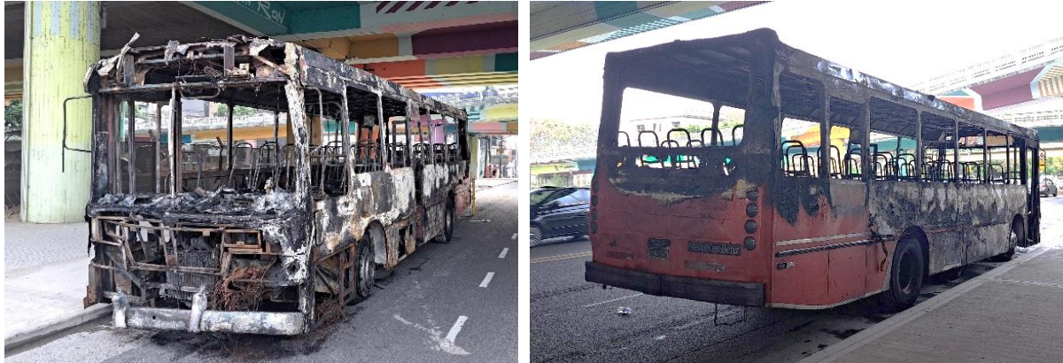
Figura 4. Daños en el exterior del vehículo. Fuente: JST, 2023
