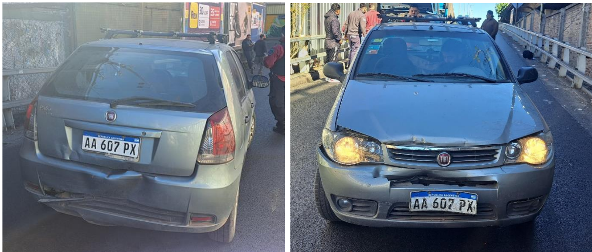
Figura 8. Daños ocasionados en las colisiones con el Vehículo 2 y el Vehículo 4. Fuente: JST, 2023
