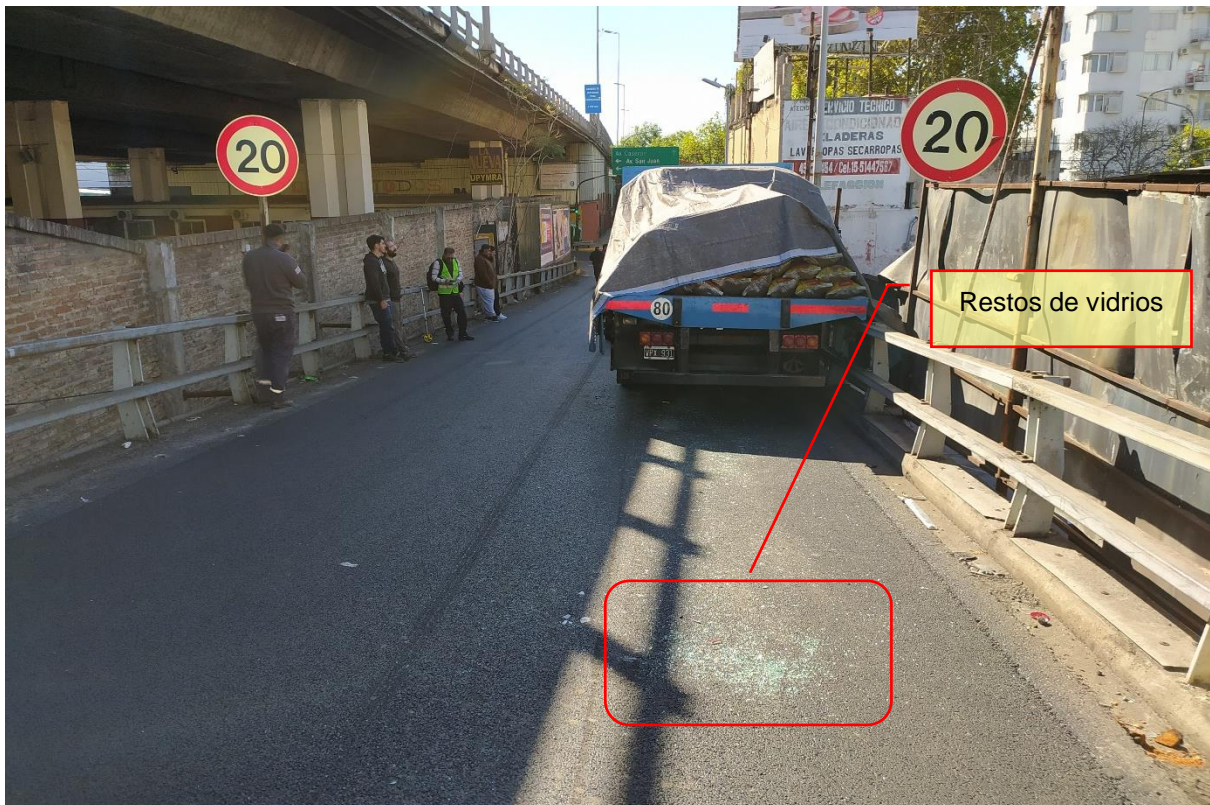
Figura 14. Restos de luneta que indicaron la zona de colisión entre el Vehículo 1 y Vehículo 2.
