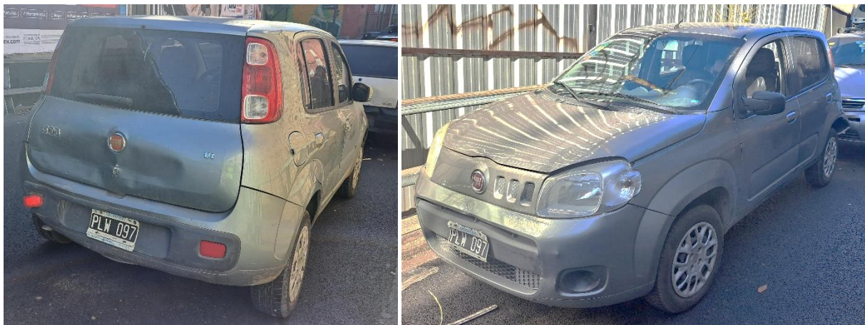
Figura 9. Daños ocasionados en las colisiones con el Vehículo 3 y Vehículo 5. Fuente: JST, 2023
