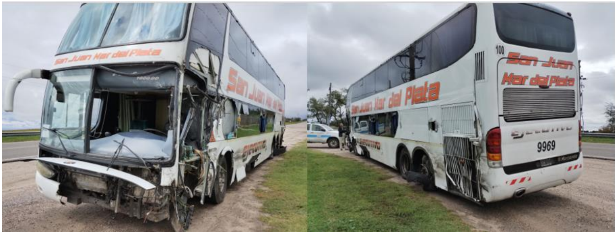
Figura 9. Daños constatados en el Vehículo 2. Fuente: JST, 2023
