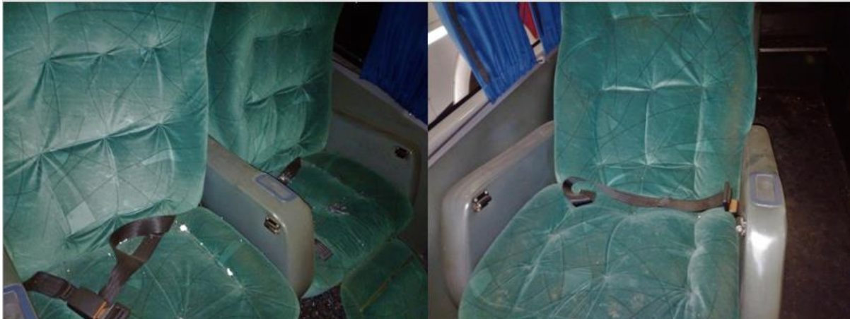
Figura 12. Estado de conservación de las butacas del Vehículo 1 y de sus respectivos cinturones de seguridad de dos puntos, con accesibilidad y en funcionamiento para su uso. Fuente: JST, 2023
