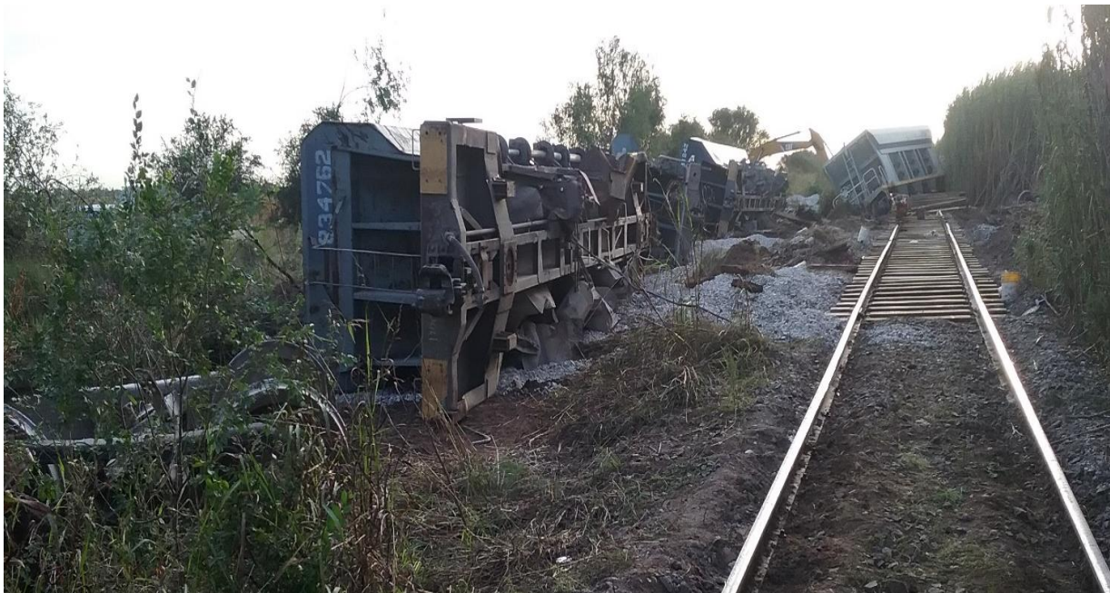
Figura 1. Vagones descarrilados, pérdida de carga y desprendimiento de bogies. Fuente: JST, 2023
